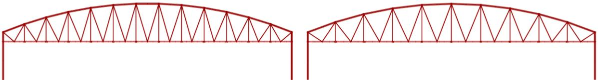
*Figura 40* Possibili configurazioni geometriche: variazione inclinazione dei diagonali.
