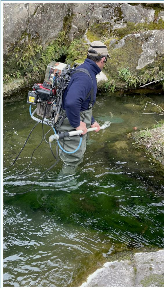
*Figura 4.2: Campionamento HMU con elettroscorditore spallabile.*
