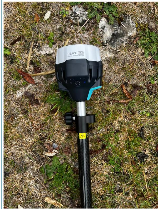
*Figura 4.15: Antenna e asta per la misura del punto stazione.*
