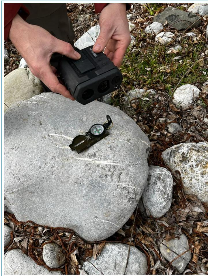
*Figura 4.11: Operazione di calibrazione telemetro laser.*
