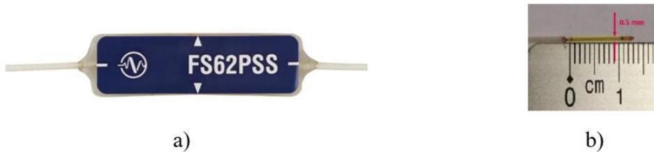
Figura 9 - a) Estensimetro Patch FBG, b) Fibra ottica in cui è fotoinciso il reticolo di Bragg
