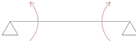
Figura 26 - Convenzione positiva delle rotazioni
