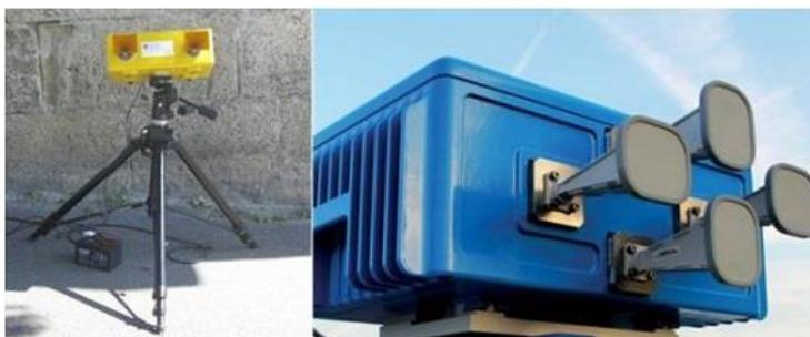
Figura 2 - Radar interferometrico terrestre
