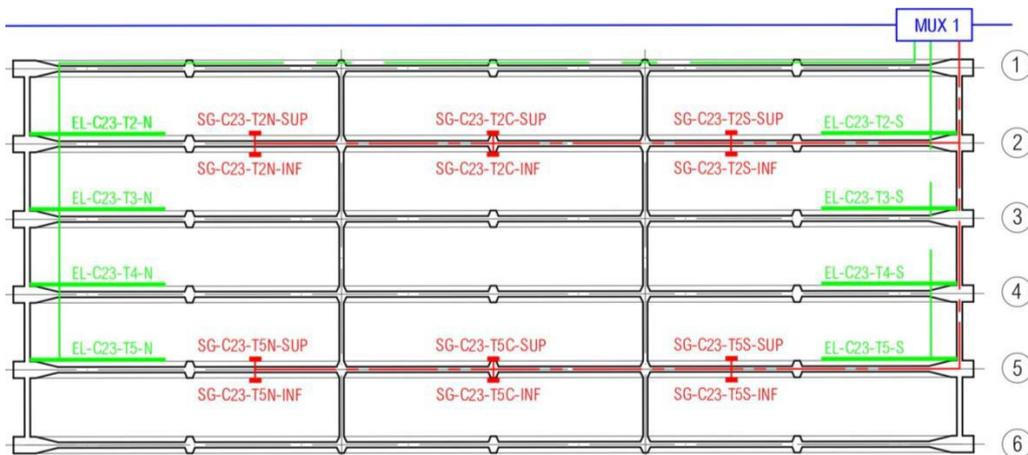
Figura 22 - Disposizione dei sensori sulle travi
