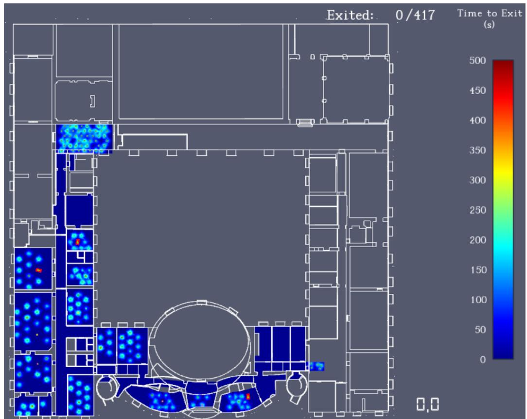
Figura 93 Tempi di uscita degli occupanti nell'istante iniziale, quinto piano, Config.1.
