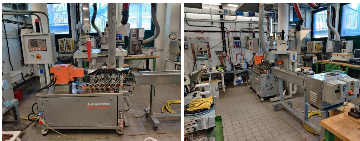
Figura 2.16: Estrusore Leistritz ZSE 18 HP
