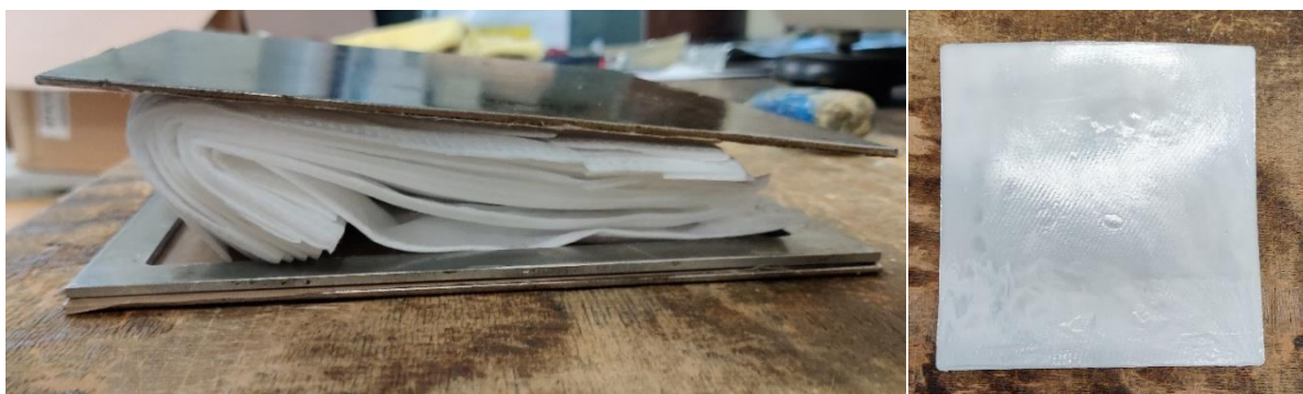
Figura 2.12: Disposizione delle mascherine nuove nello stampo e piastrella di mascherine pressate
