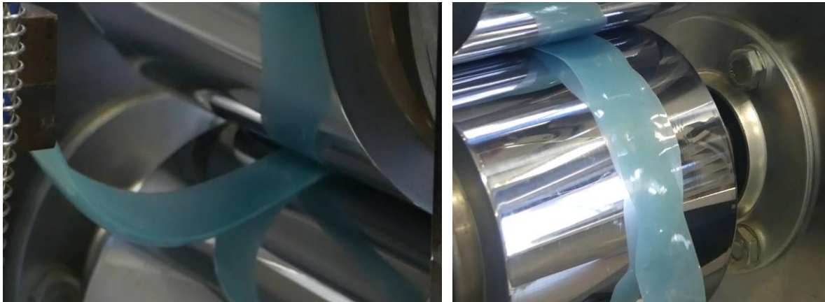
Figura 3.34: Film 70% mascherine nuove senza elastico e 30% mascherine usate
