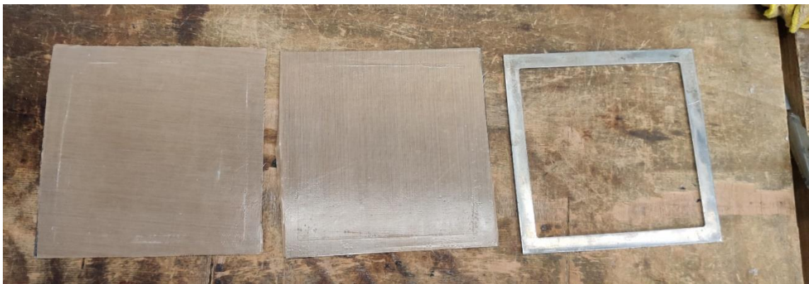
Figura 2.11: Le due lastre metalliche ricoperte da Teflon e lo stampo
