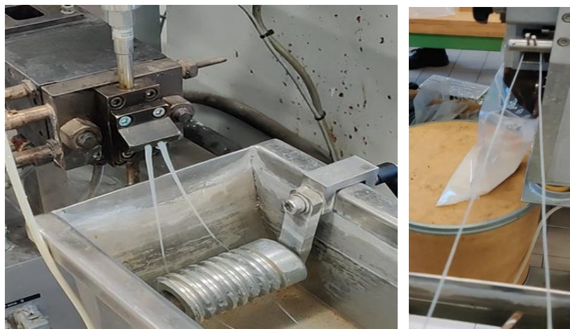
Figura 3.28: Filamenti di mascherine nuove senza elastico
