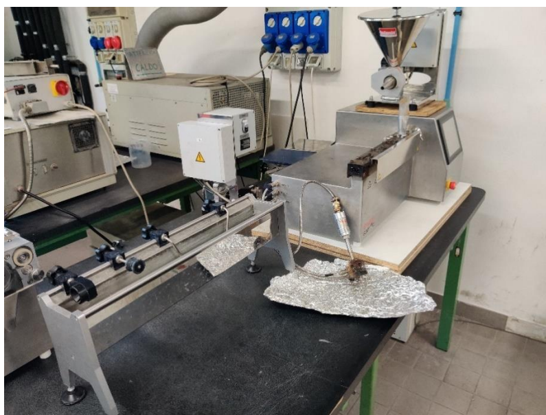
Figura 2.21: Estrusore Thermo Fisher
