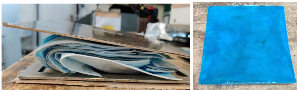
Figura 2.13: Disposizione delle mascherine usate nello stampo e piastrella di mascherine pressate
