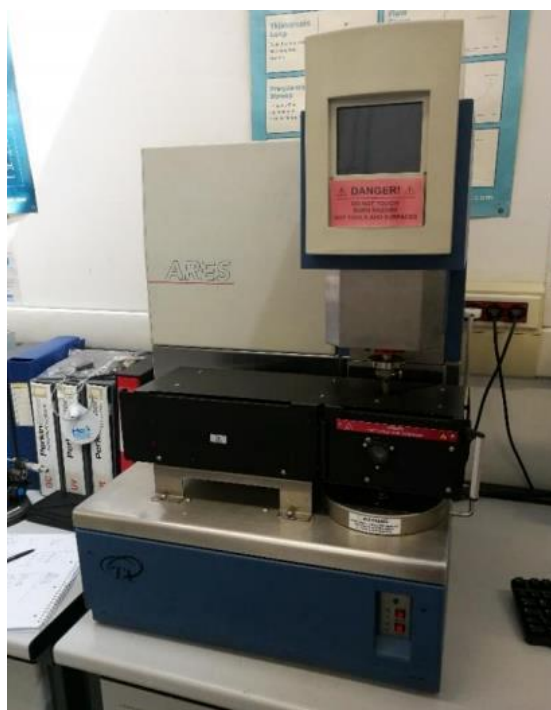
Figura 2.28: Reometro rotazionale Ares
