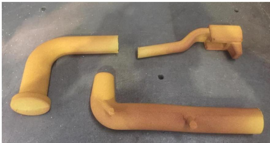
**[Figura 1.3]:** Alcuni esempi di anime formate ed impiegate presso la fonderia nella formatura di componenti che richiedono una cavità.
