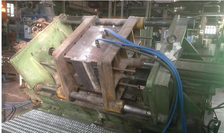
**[Figura 1.1]:** Esempio di conchiglia, con la rispettiva conchigliatrice, presente in stabilimento. In particolare, la macchina qui riportata è in grado di basculare, com'è visibile in figura.
