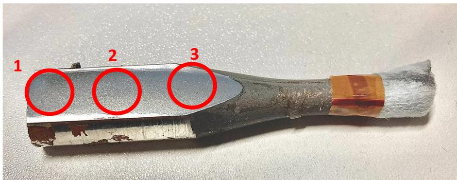
[Figura 2.3]: Provino lucidato ed attaccato con HF allo 0,1%. Le tre zone dove sono state eseguite le micrografie per ciascun provino sono riportate in figura.
