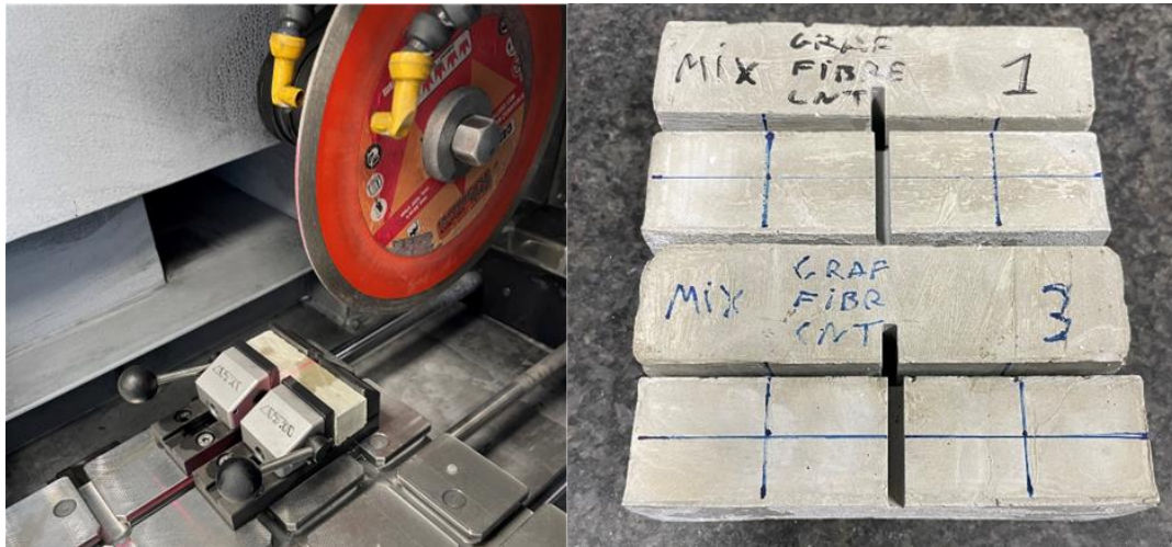
Figura 50: A sx procedimento per intagliare i provini prima di effettuare la prova a flessione in CMOD con macchina da taglio Brillant 220, a dx provini intagliati.
