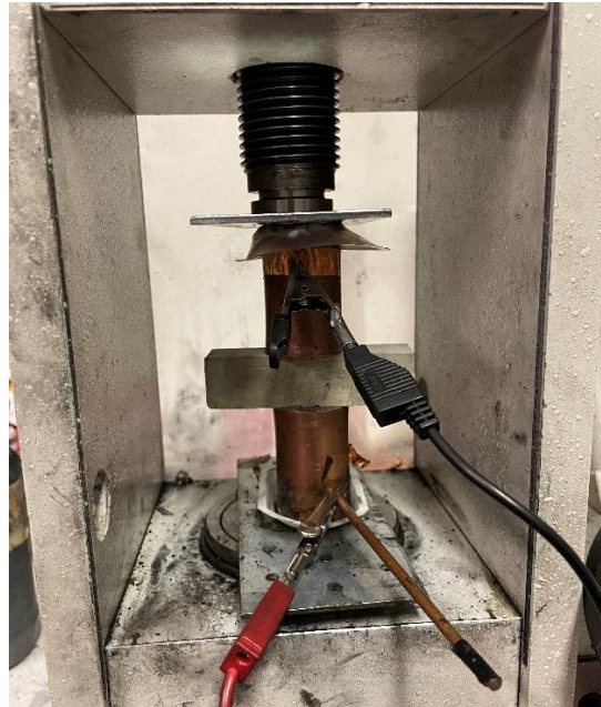
Figura 54: Strumento utilizzato per la valutazione della resistività elettrica.
