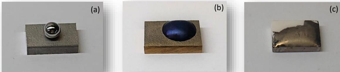
**Figura 4.4** – Immagini macroscopiche di *B-Ti5* prima (a) e a seguito della prova di goccia sessile, effettuata dal CNR di Genova, su substrati di *C-22®* (b) e *allumina* (c)
