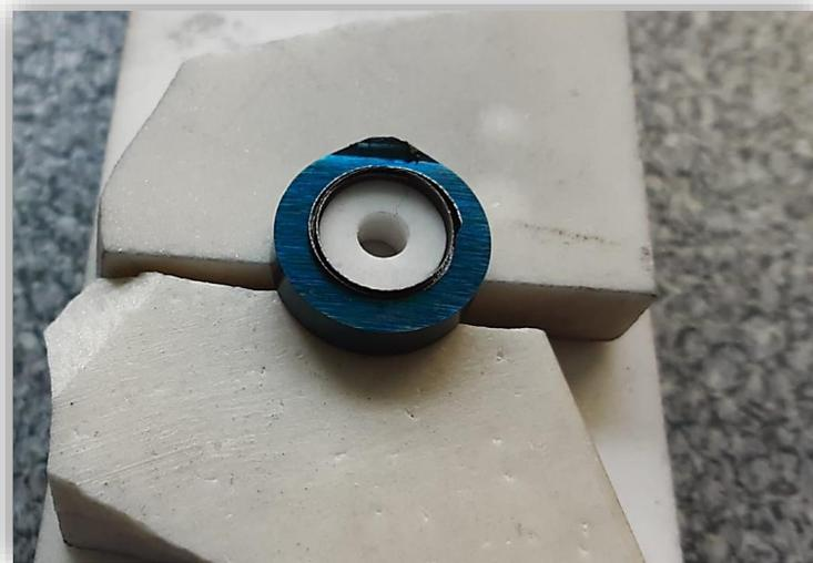
**Figura 4.3** – Campione macroscopico di giunzione dissimile ossidata realizzata in forno tubolare operante in condizioni vuoto nominale di  $10^{-5}$  mbar e alta T
