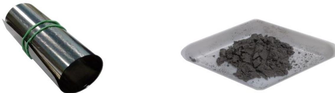
**Figura 3.1** – Foglio di *B-Ti5* o *TiBraze620* (a) e polvere di *B-Ti5* (b)
