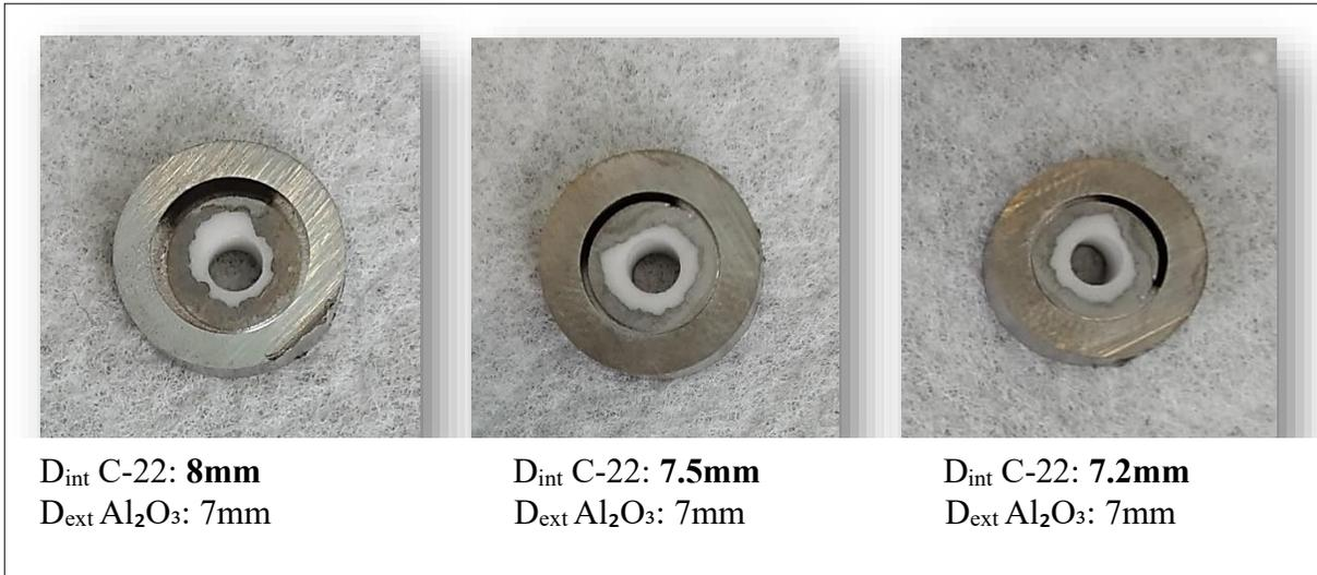
**Figura 4.29** – Tre campioni di giunzione allumina/B-Ti5foglio/C-22 dopo il trattamento di brasatura effettuato a  $900^\circ\text{C}$  per 12 min a tre diversi valori di  $D_{\text{int}}$  per il tondino di C-22
