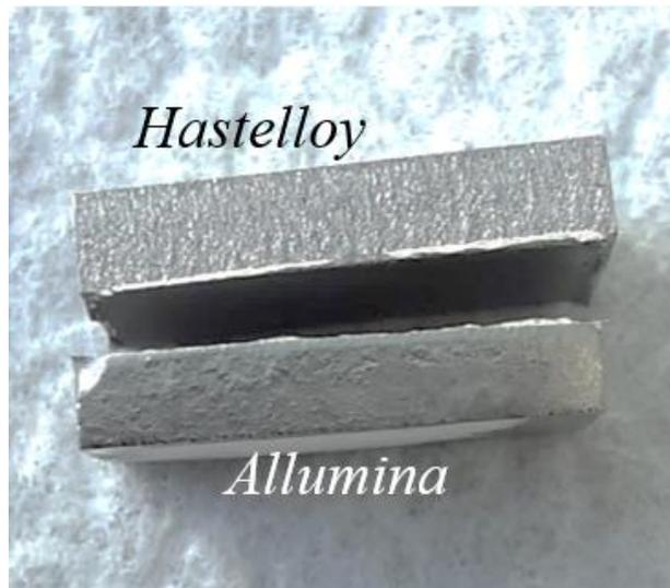
*Figura 4.22* – Immagine macro della giunzione allumina/B-Ti5/C-22 a seguito del trattamento termico riportato in *Tabella 3.8*
