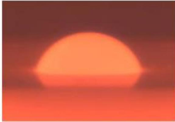
**Figura 2.3** – Prova della goccia sessile per un metallo su una superficie solida (in questo caso allumina) al fine di valutarne la bagnabilità tramite la successiva misura dell'angolo di contatto (Figura 2 [41])
