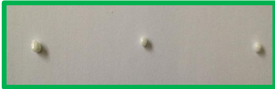
Figura 4.24. Prova con YAG amorfo e substrato di SiC, con cinque cicli. Numero di repliche tre.
