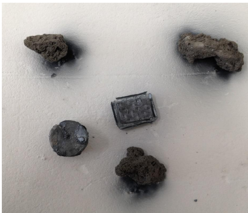
Figura 3.12. Campione prelevato dal forno. Il campione poggia su allumina porosa. Sono state collocate tre spugne di Titanio per assorbire residui di ossigeno. Il peso posto sopra al campione è il cilindro di tungsteno presente nelle immagini.
