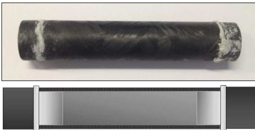
Figura 2.5 Componente cilindrico di SiC/SiC sigillato tramite due elementi di chiusura in SiC/SiC, con relativo schema in sezione. Il campione dopo la giunzione presenta una lunghezza di 59.60 mm circa.
