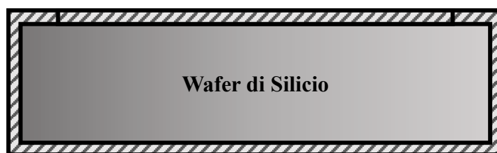
Figura 3.7 Schema del sistema Mo-wrap. Il wafer di silicio è avvolto dai fogli di molibdeno, con alette ripiegate verso l'interno.
