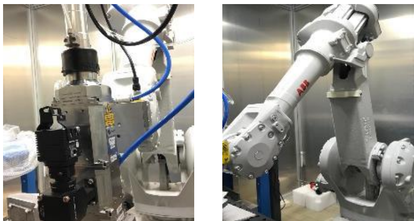
Figura 4.12. Particolare della testa laser e del braccio robotico.
