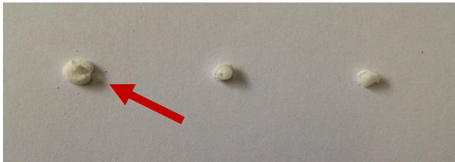
Figura 4.23. Prova con YAG amorfo e substrato di SiC, con cinque cicli. Numero di repliche tre.
