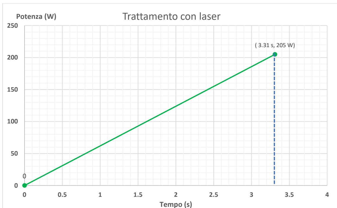
Figura 4.28 Grafico del processo termico impostato tramite valore di potenza massima (205 W) e tempo (3.31 s). Il laser non eroga potenza in fase di discesa.
