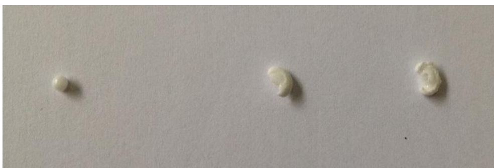
Figura 4.19. Prova con YAG amorfo e substrato di allumina, con due cicli. Numero di repliche 3.
