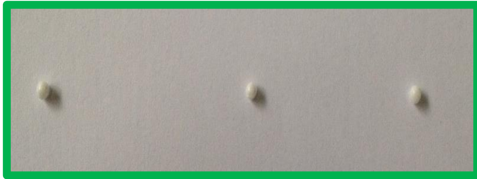
Figura 4.22. Prova con YAG amorfo e substrato di allumina, con cinque cicli. Numero di repliche tre.
