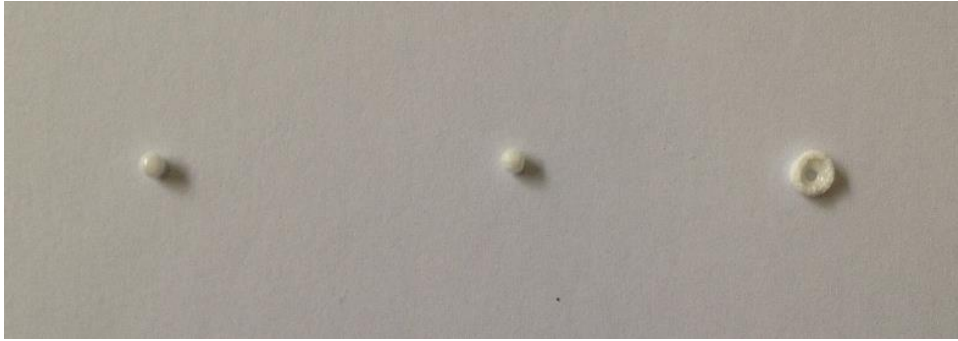
Figura 4.20. Prova con YAG amorfo e substrato di allumina, con tre cicli. Numero di repliche tre.
