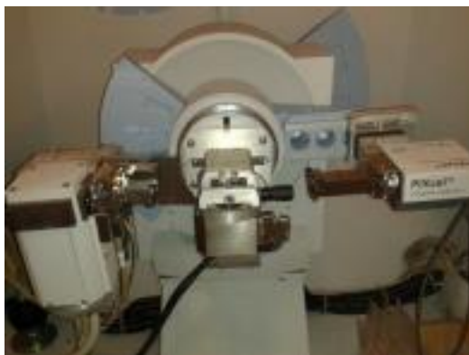
Figura 1.17. Immagine del diffrattometro a raggi X, X'Pert MPD DY 1165, situato presso i laboratori di analisi del DISAT [46].
