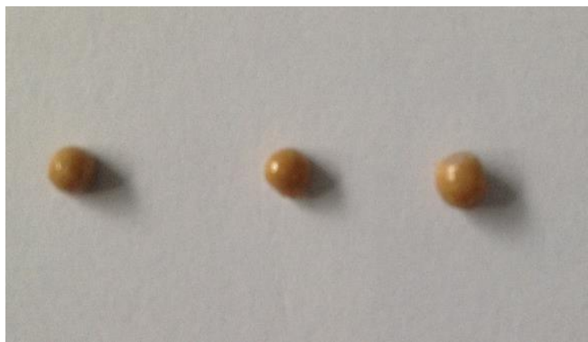
Figura 4.14 Risultato ottenuto dal riscaldamento della polvere di YAG amorfo, su substrato di allumina.
