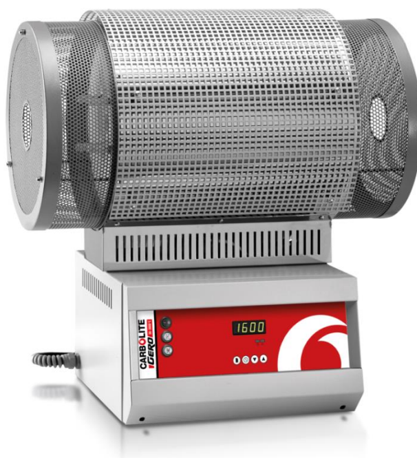
Figura 1.12 Immagine forno carbolite gero. L'immagine rappresenta il forno privo di tubo in allumina [45],[49].
