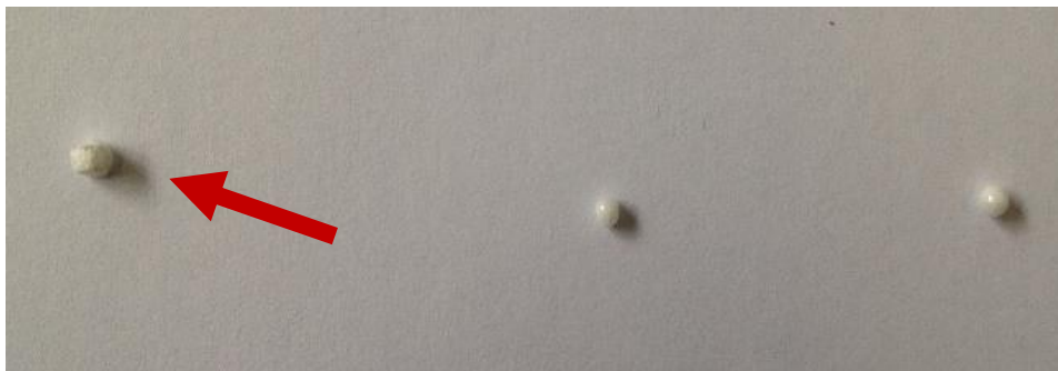
Figura 4.21. Prova con YAG amorfo e e substrato di allumina, con quattro cicli. Numero di repliche tre.
