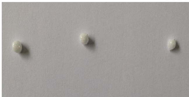
Figura 4.15 Risultato ottenuto dal riscaldamento della polvere di YAG amorfo, su substrato di SiC.
