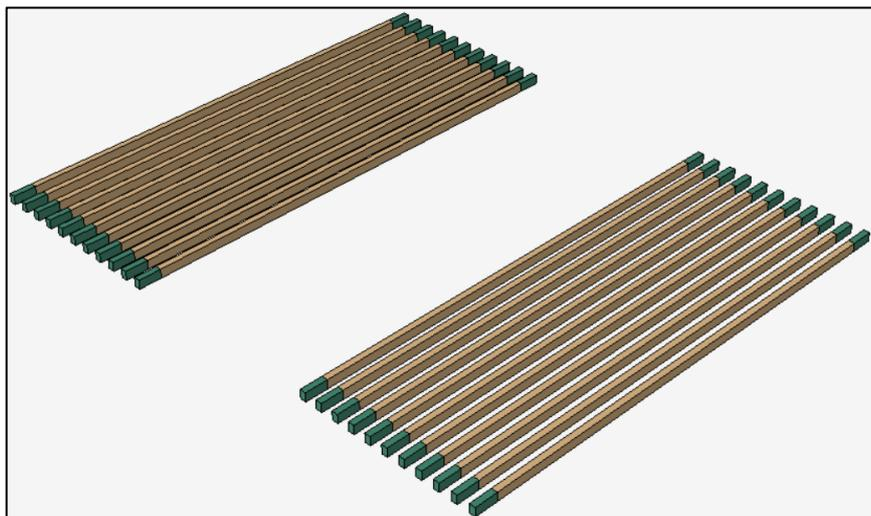
Figura 73: Travetti tipo B piano terra
