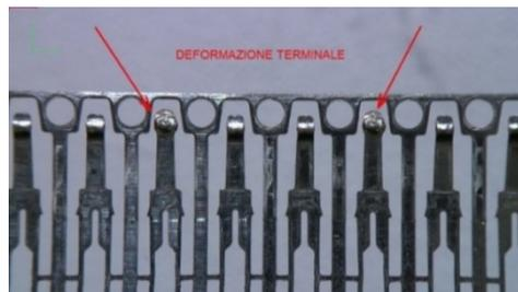
Figura 3.2 - Deformazione terminale connettore Multifitting
