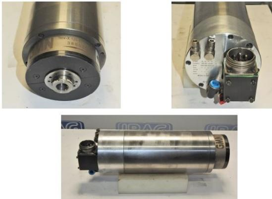
**Figura 6.2:** Un esempio di elettromandrino marca GMN
