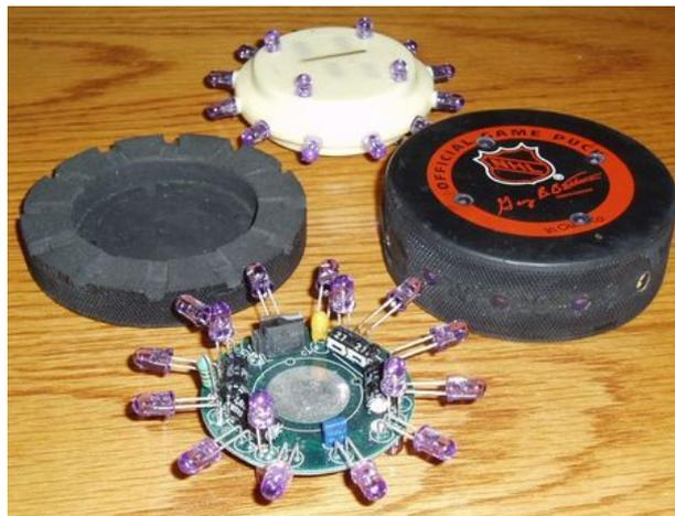
**Figura 2.8:** Un disco da Hokey funzionante con il sistema Fox-Trax
