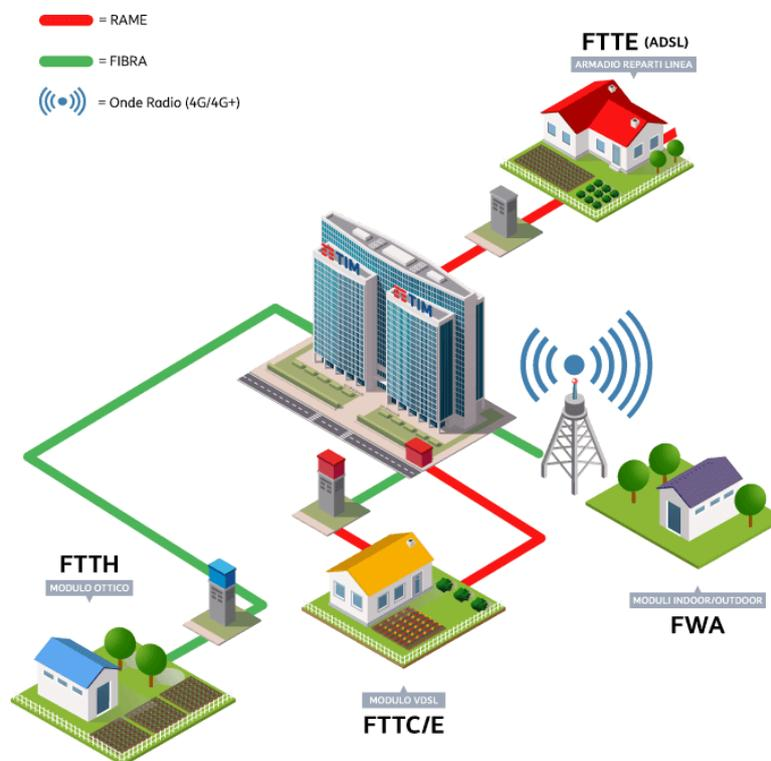
Figura 1.10 - Principali Architetture FTTx
