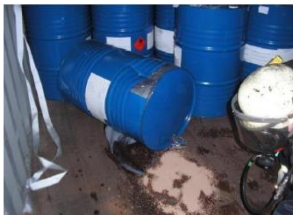
Figura 1.9 – Merci liquide pericolose rovesciate Fonte: CTU Code, informative material 1
