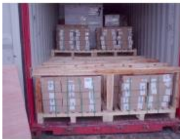
Figura 2.7 – Pavimento temporaneo in legno
