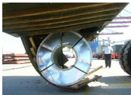
Figura 1.11 – Pavimento UTI sovraccaricato
