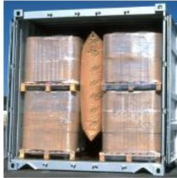
Figura 2.4 – Gap riempito con sacchi Fonte: CTU Code, annex 7
