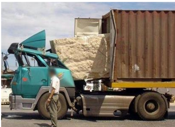
Figura 1.6 – Mancanza di fissaggio longitudinale Fonte: CTU Code, informative material 1
