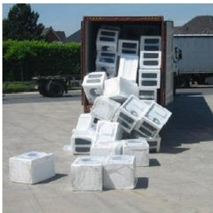
Figura 1.8 – Pacchi non fissati Fonte: CTU Code, informative material 1
