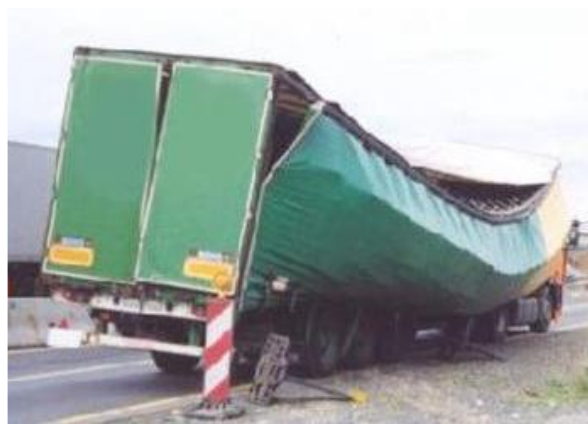
Figura 1.7 – Resistenza inadeguata parete laterale Fonte: CTU Code, informative material 1
