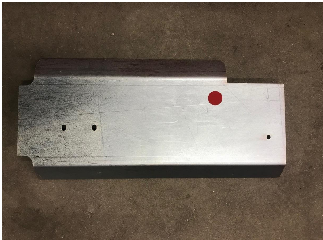
Figura 25: Esempio di articolo non conforme con bollino rosso che evidenzia un controllo con esito negativo
