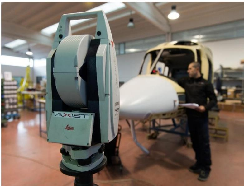
Figura 4.1 – Misure su elicottero, Laser Tracker Leica AT 401, Axist
