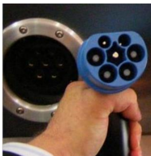
Figura 13 (Presa di tipo 2)
