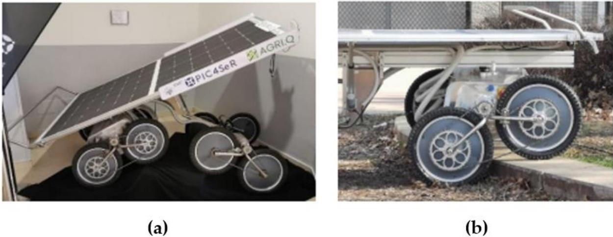
*Figura 3: Dettaglio sulla distribuzione di forze su un'ampia superficie (a); Dettaglio sul funzionamento da filtro delle oscillazioni (b)*
