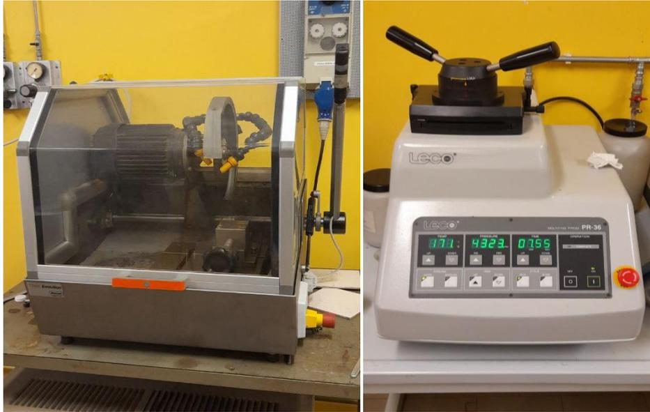
Figura 50 (a) Troncatrice metallografica a sinistra (b) Macchinario per inglobare i campioni a destra
