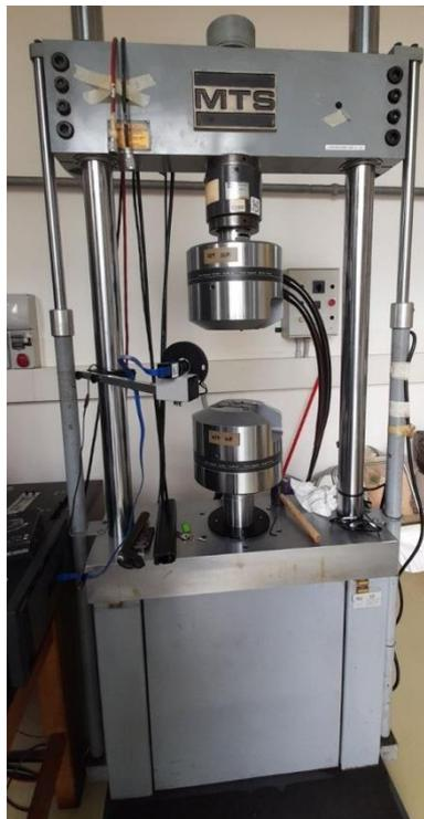
*Figura 25 Macchina di trazione usata nelle prove sperimentali*
