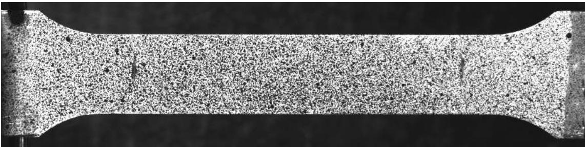
*Figura 4 Pattern stocastico su un provino per prova di trazione*
