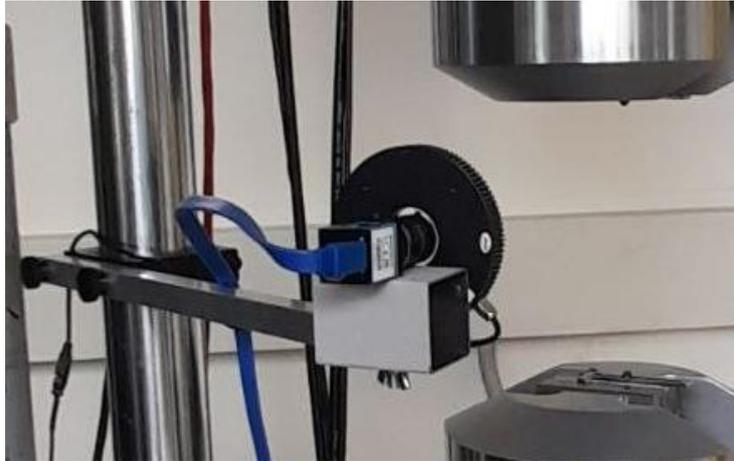
*Figura 3 Fissaggio della telecamera alla macchina di trazione*
