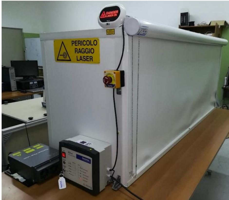
Figura 3.12: isolamento della sorgente laser
