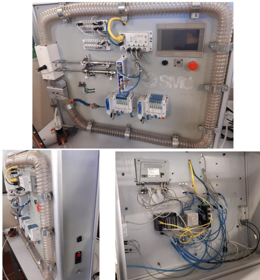
Figura 1: fotografie del pannello Smc con vista frontale, laterale e posteriore
