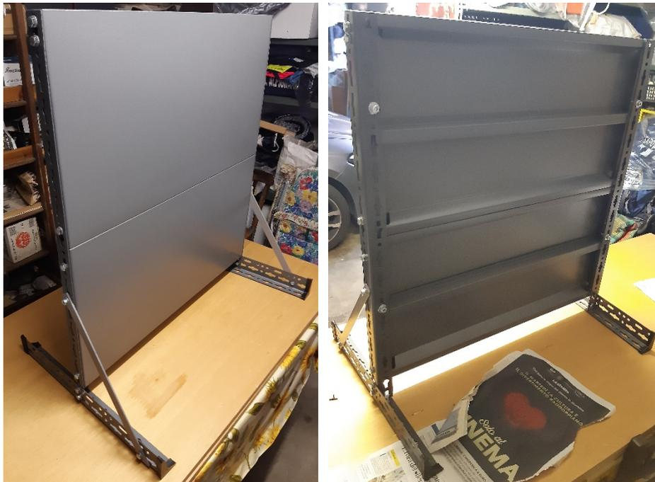
*Figura 101: struttura portante del pannello didattico di espansione*
