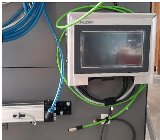
*Figura 107: installazione del pannello di interfaccia nella cornice di alluminio dedicata*
