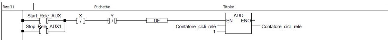
Figura 68: realizzazione del contatore del numero di cicli realizzati
