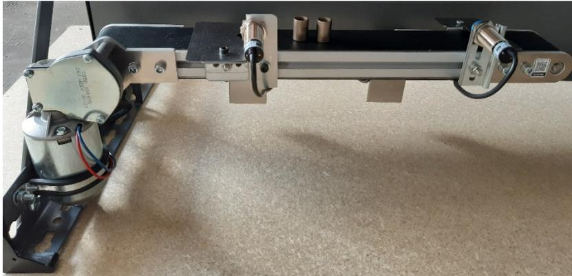
*Figura 103: posizionamento del nastro trasportatore*
