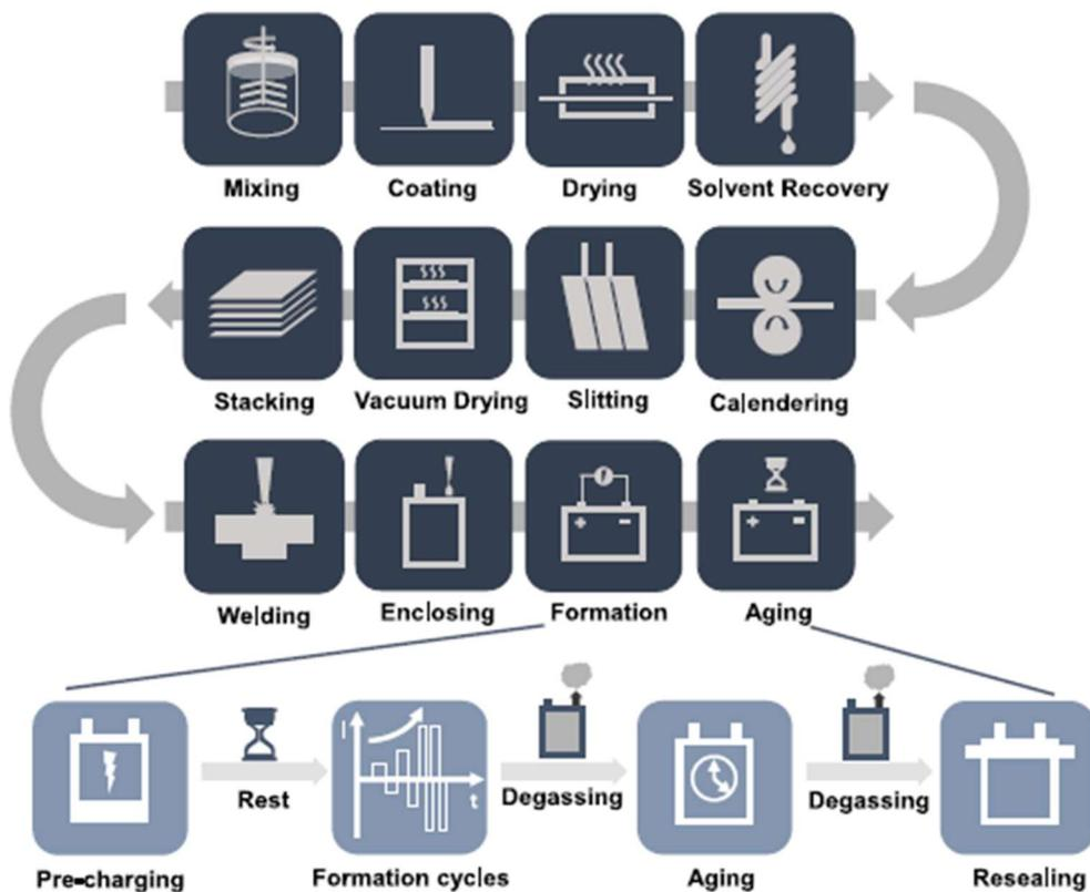
Figura 2.6 - Fasi del processo di produzione di una batteria agli ioni di litio (iScience, 2021)
