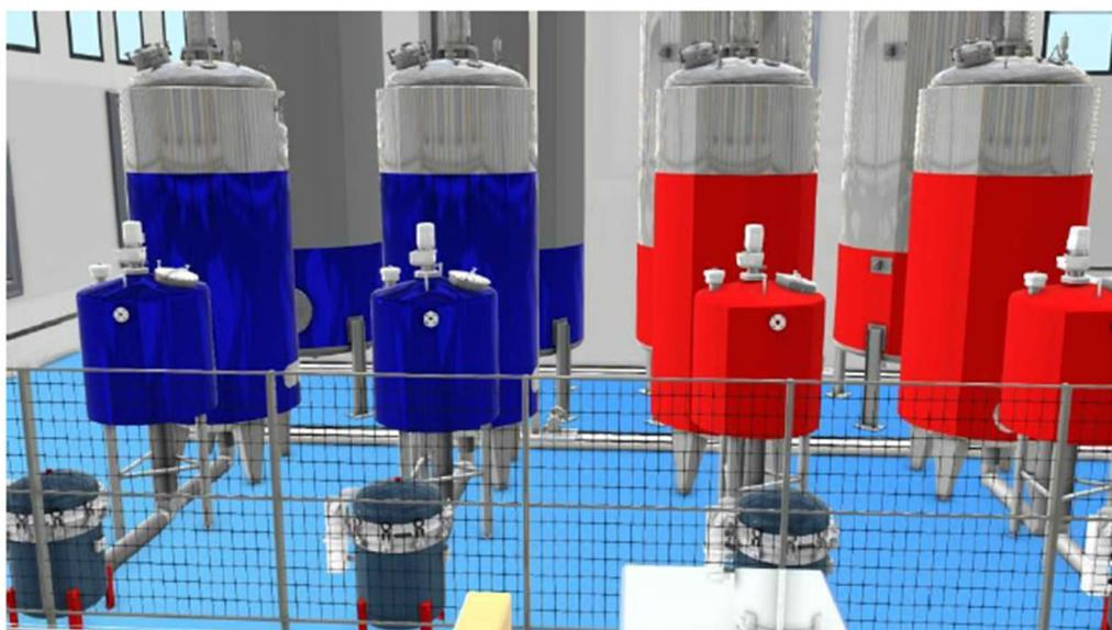
Figura 3.16 - Area destinata alla fase di mixing per l'anodo (blu) e catodo (rosso) (University of VAASA, 2018)
