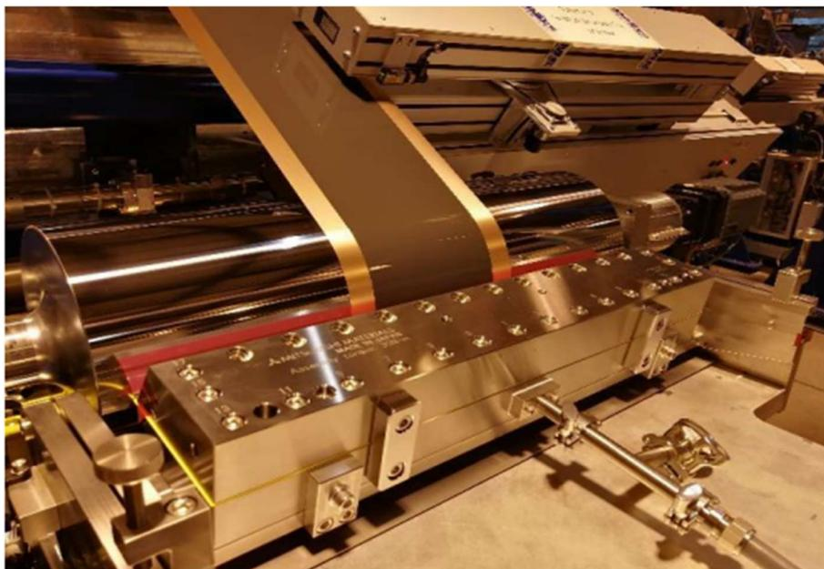
Figura 2.13 - Esempio di un coater continuo (TMAX BATTERY EQUIPMENTS)
