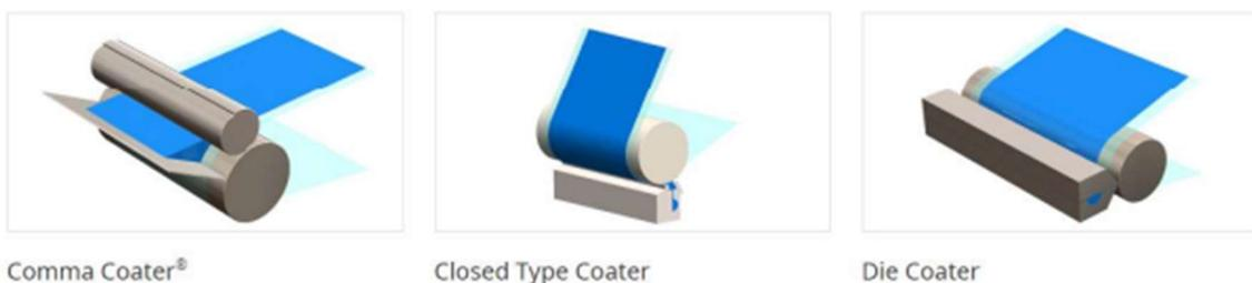
Figura 2.11 - Esempi delle tecniche di coating (FAAM, 2019)
