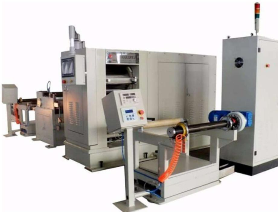
Figura 2.17 - Esempio di calender che utilizza il processo roll-to-roll (TMAX BATTERY EQUIPMENTS)
