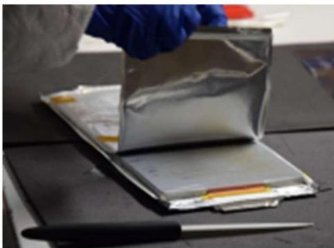
*Figura 2.24 - Sigillatura di una cella pouch (TMAX BATTERY EQUIPMENTS)*
