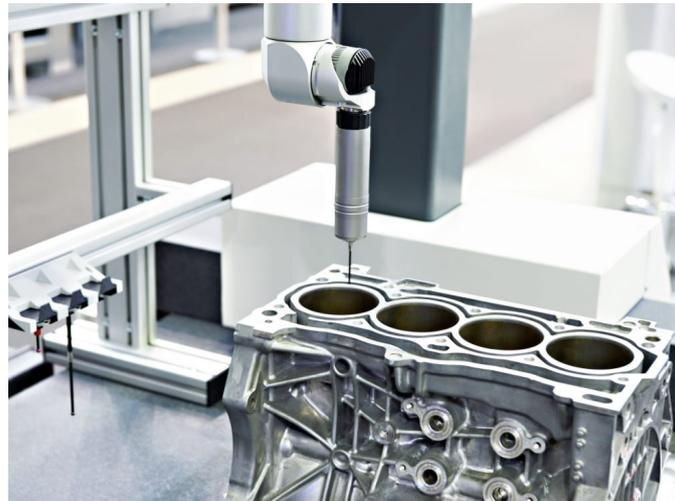
Figura 6.7: esempio di componente analizzato con una sonda [30]
