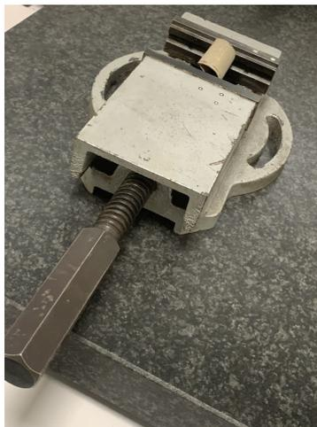
Figura 7.1: Componente bloccato tramite l'uso di una morsa
