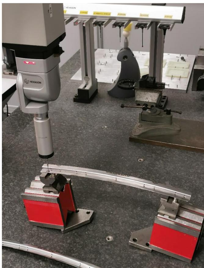
*Figura 8.2: Misurazione dei pezzi con CMM (Sacel S.r.l.).*
