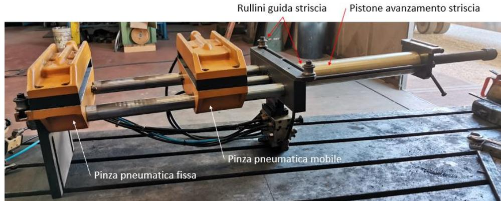
Figura 3.48: Alimentatore pneumatico [25].
