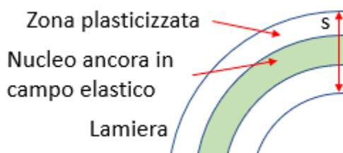
Figura 3.19: Schema delle zone in campo plastico ed elastico di una lamiera in fase di piegatura.
