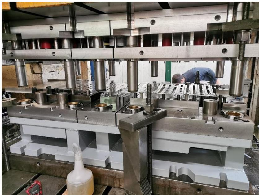
*Figura 3.37: Basamento dello stampo in acciaio saldato (Sacel S.r.l.).*
