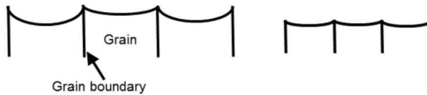
Figura 3.27: A sinistra grana grossa ed increspature elevate (effetto buccia d'arancia più evidente); a destra i grani sono piccoli e l'effetto ad occhio nudo è meno evidente [24].
