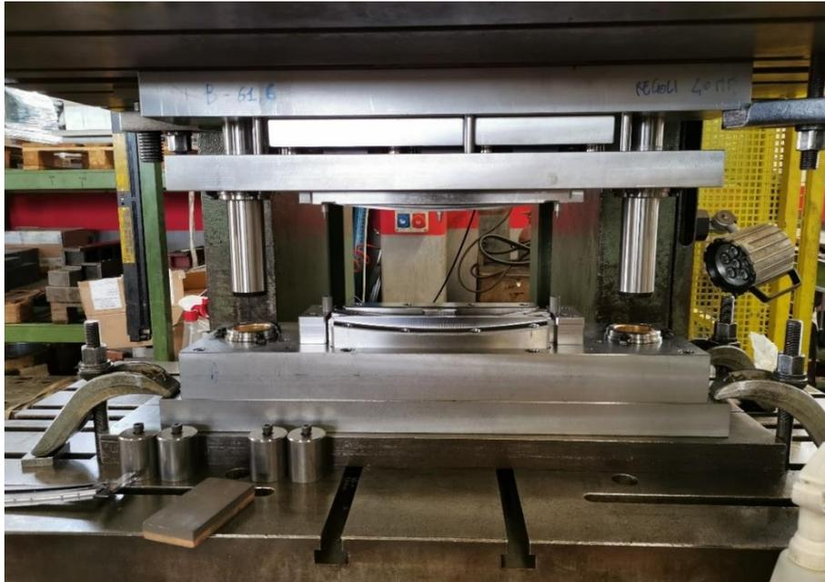
Figura 6.9: Stazione di piega staffata alla pressa per l'esecuzione delle prove stampo (Sacel S.r.l.).
