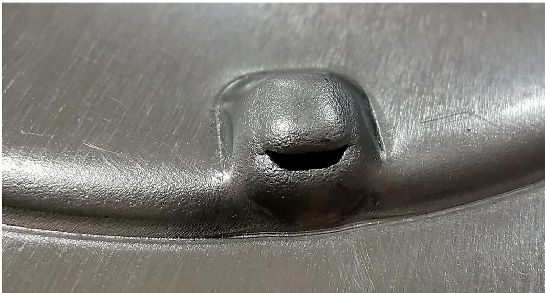
*Figura 3.24: Strappo sul fondo di una bugna di un componente in alluminio (Sacel S.r.l.).*
