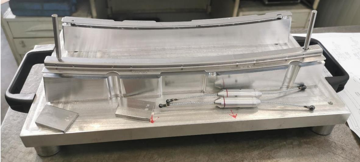
Figura 6.25: Calibro di controllo (Sacel S.r.l.).
