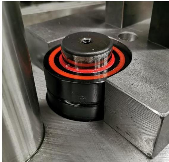
Figura 3.46: Cilindro ad azoto (Sacel S.r.l.).
