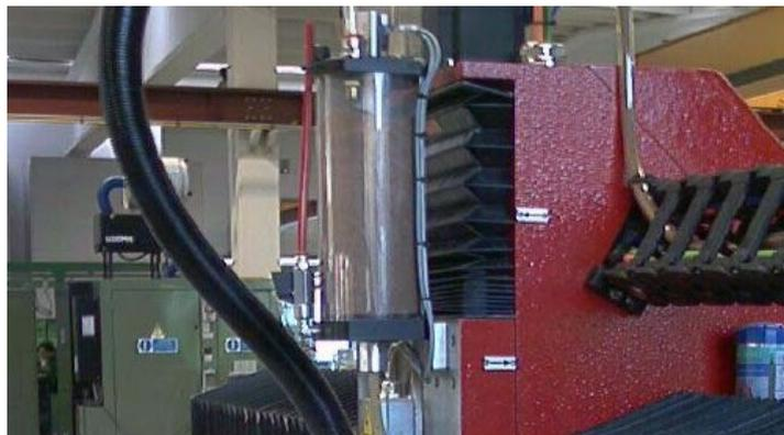
*Figura 5 - clessidra per il dosaggio dell'abrasivo*
