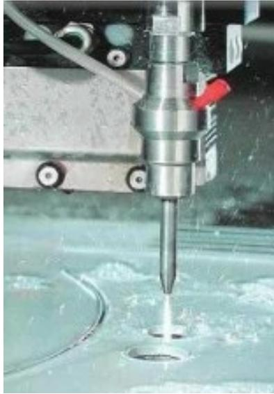
*Figura 3 - schematizzazione di una testa di taglio idroabrasiva e del meccanismo di asportazione del materiale*
