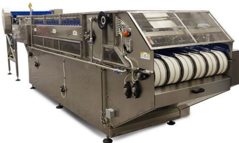
La **denocciolatrice di albicocche modello CTI-1000** e modello **CTI-1200**, orienta, denocciola e divide in due l'albicocca. Queste macchine lavorano fino a 1200 frutti al minuto nella versione a 6 canali e fino a 1000 frutti al minuto nella versione a 5 canali, a seconda delle condizioni del frutto.
