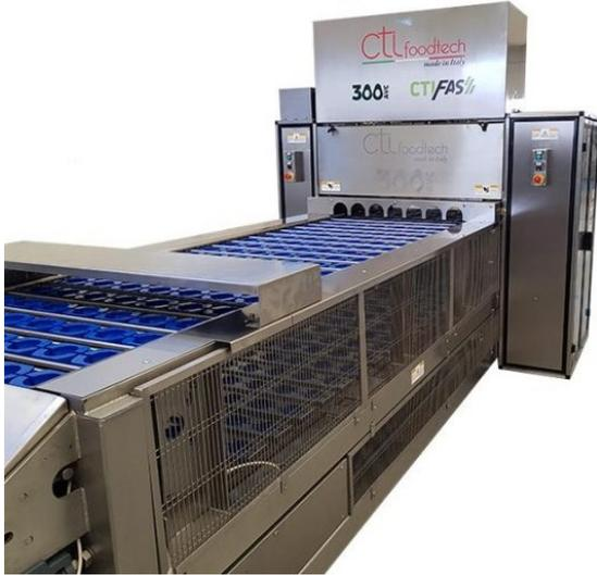
La **denocciolatrice di avocado modello 300-AVC** alimenta e denocciola avocado piriformi a una velocità meccanica fino a 280 frutti al minuto. I frutti vengono convogliati nell'alimentatore. Un sistema di shuffle feeder posiziona e orienta i frutti in verticale, individualmente, negli alveoli delle placche portafrutto. Nella fase di taglio, due coltelli tagliano i frutti dall'alto e dal basso. Successivamente un espulsore
