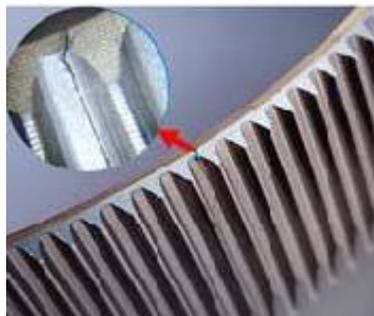
Figura 4.8: Propagazione della cricca verso il bordo della *flexspline* [14]
