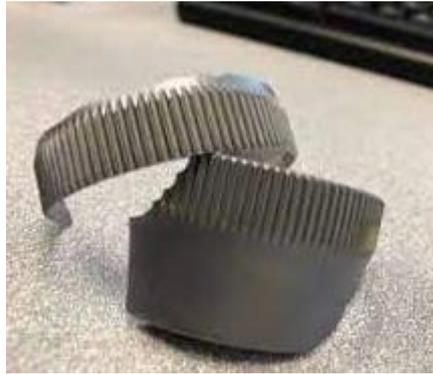
Figura 4.9: Collasso fragile della *flexspline* [26]
