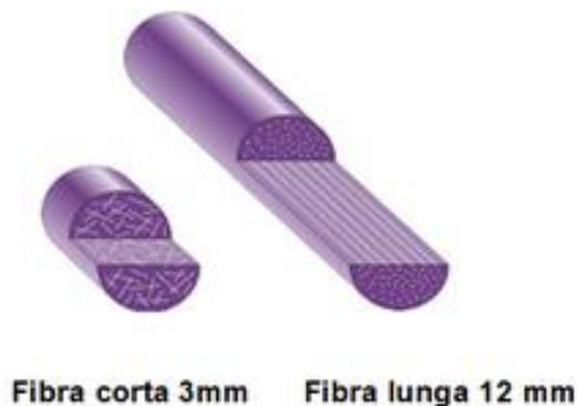
Figura 2.12: Pellet compositi di fibra corta e fibra lunga
