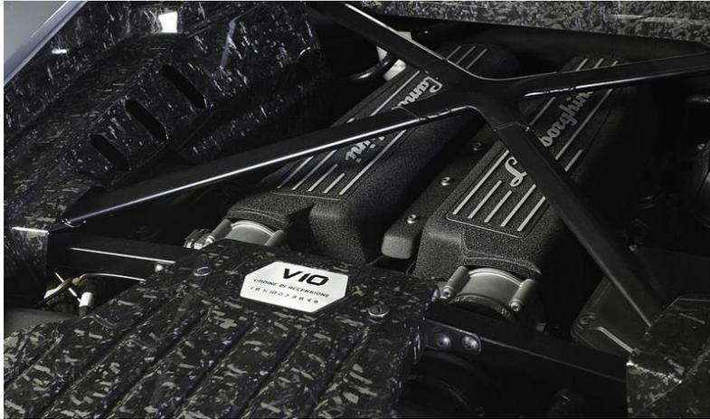
Figura 2: Vano motore della Lamborghini progettato con il loro SMC, Forged Composites®
