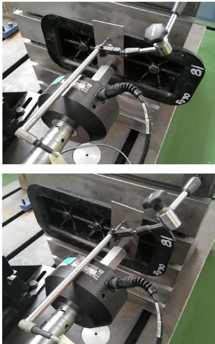
*Figura 11.1: In alto, rilevazione spostamento nel caso di forzante centrale. In basso, con forzante laterale.*
