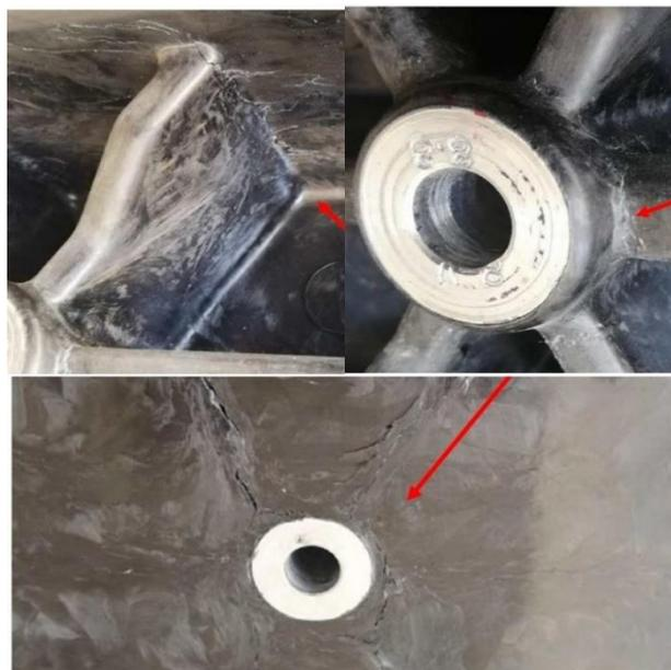
Figura 11.6: Zone di Rottura Sperimentali
