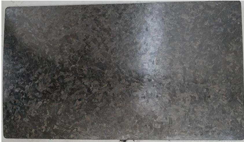
*Figura 6.3: Esempio di lastra piana in SMC*
