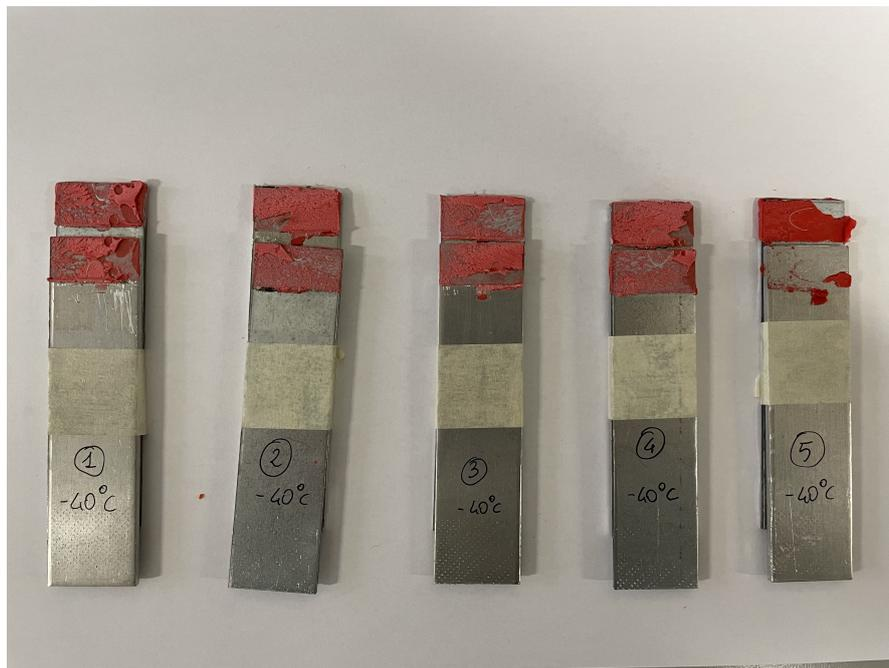
**Figura 5.10:** Superfici di frattura dei campioni sottoposti a prova di trazione a temperatura di  $-40^{\circ}\text{C}$ .
