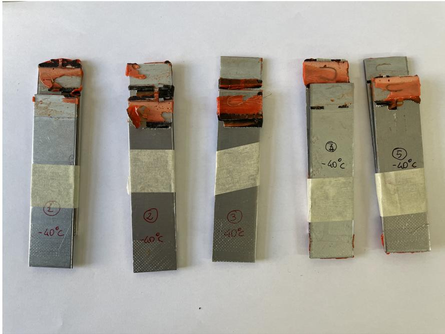
**Figura 5.22:** Superfici di frattura dei campioni sottoposti a prova di trazione a temperatura di  $-40^{\circ}\text{C}$ .
