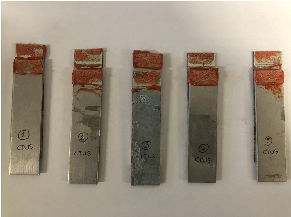
**Figura 5.20:** Superfici di frattura dei campioni invecchiati 500 ore in CTUS e sottoposti alla prova di trazione a temperatura ambiente con adesivo specifico per giunti in alluminio
