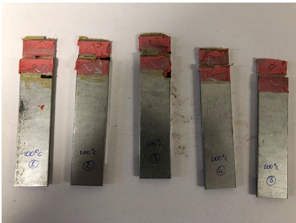
**Figura 5.4:** Superfici di frattura dei campioni sottoposti ad invecchiamento di 500 ore a 100°C e prova di trazione a temperatura ambiente
