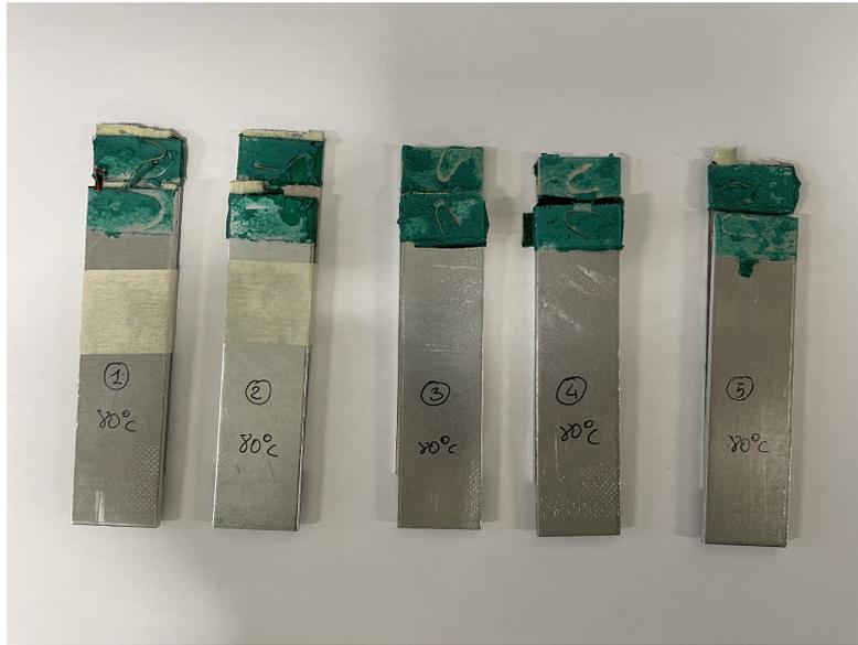
**Figura 5.36:** Superfici di frattura dei campioni sottoposti a prova di trazione a temperatura di 80°C.
