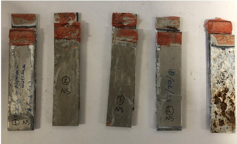
**Figura 5.17:** Superfici di frattura dei campioni invecchiati 500 ore in nebbia salina e sottoposti alla prova di trazione a temperatura ambiente con adesivo specifico per giunti in alluminio
