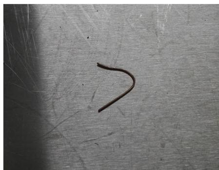
**Figura 3.2:** Filo di rame di diametro 0,5 mm e forma a V, utilizzato nei provini per le prove di resistenza a distacco per taglio.
