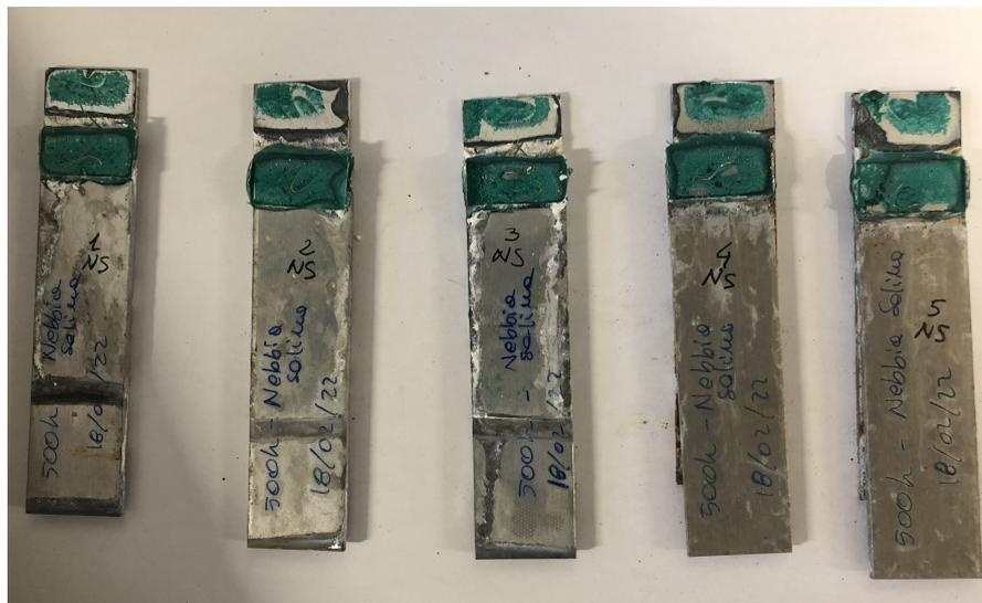
**Figura 5.30:** Superfici di frattura dei campioni sottoposti ad invecchiamento 500 ore in nebbia salina e prova di trazione a temperatura ambiente.
