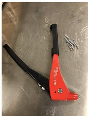
**Figura 6.4:** rivettatrice manuale e rivetti utilizzati
