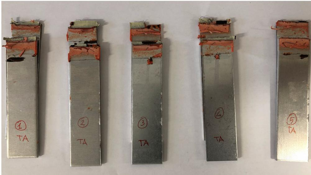
**Figura 5.14:** Superfici di frattura dei campioni sottoposti alla prova di trazione a temperatura ambiente con adesivo specifico per giunti in alluminio
