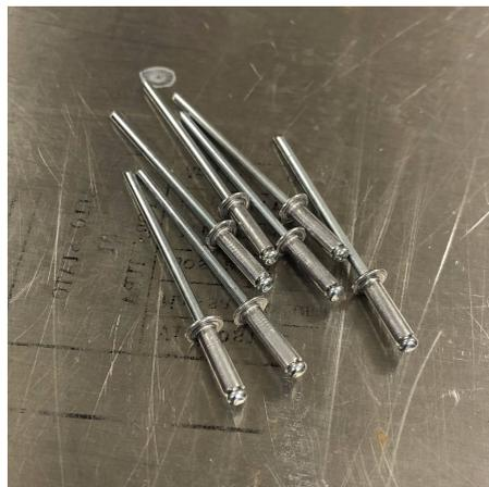
**Figura 3.1:** Tipologia di rivetti utilizzati per le prove di dilatazione termica differenziata
