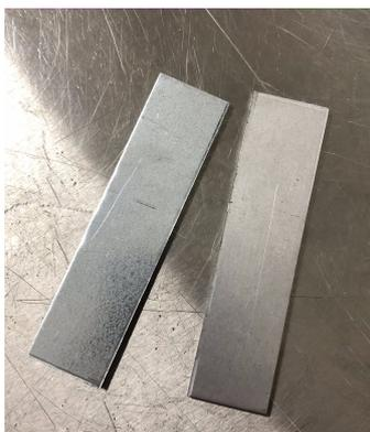
**Figura 4.1:** Lamierini utilizzati nella realizzazione dei provini per le prove di resistenza a distacco per taglio: a sinistra acciaio, a destra alluminio.
