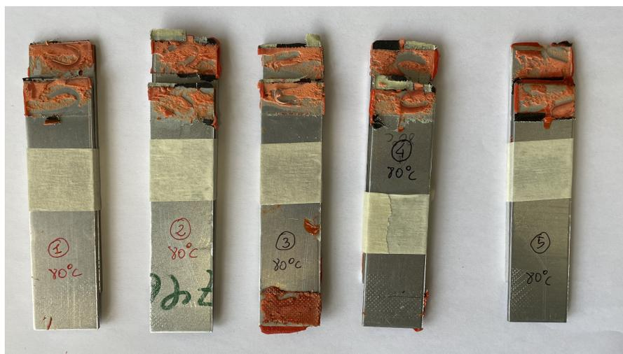
**Figura 5.24:** Superfici di frattura dei campioni sottoposti a prova di trazione a temperatura di 80°C.
