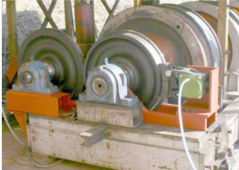
*Figura 41: Banco prova con doppia ruota [28]*
