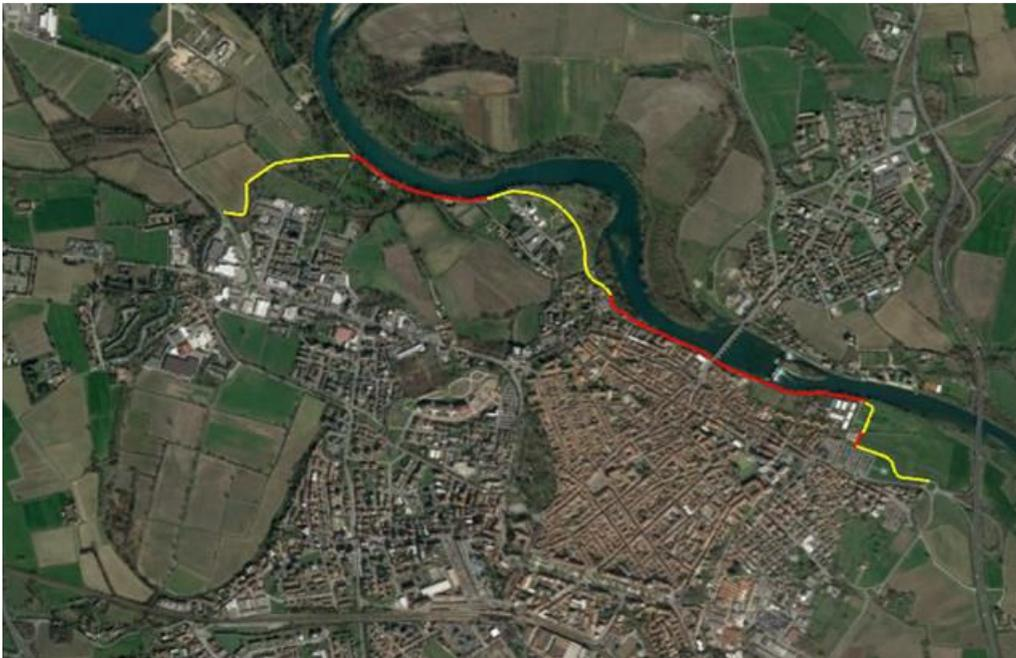
*Figura 12: Identificazione del tracciato arginale costruito a Lodi. In giallo i tratti in terrapieno, in rosso quelli in calcestruzzo*
