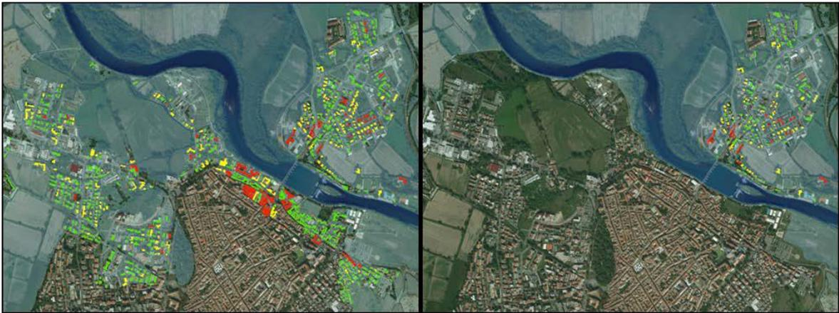
Figura 14: Mappa del danno al settore residenziale, a sinistra prima e a destra dopo la costruzione dell'opera.
