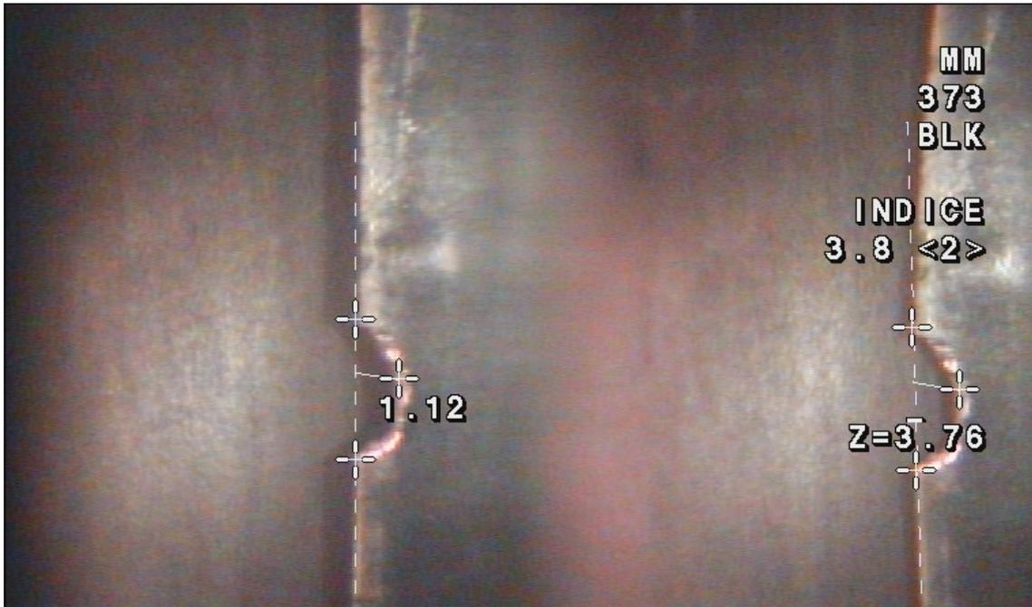
Figura 5.3: Dettaglio di alcuni intagli misurati con un software apposito. Fonte: Airgreen S.r.l.
