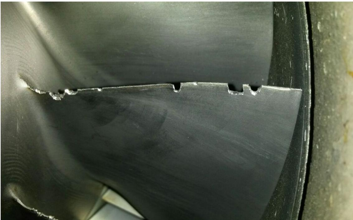
Figura 5.4: Danni da FOD molto evidenti. Fonte: Airgreen S.r.l.
