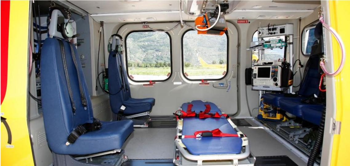
Figura 2.5: Configurazione cabina per operazioni HEMS. Fonte: [12]
