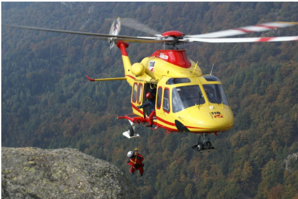
Figura 2.6: Impiego del verricello su un AW139. Fonte: Airgreen S.r.l.
