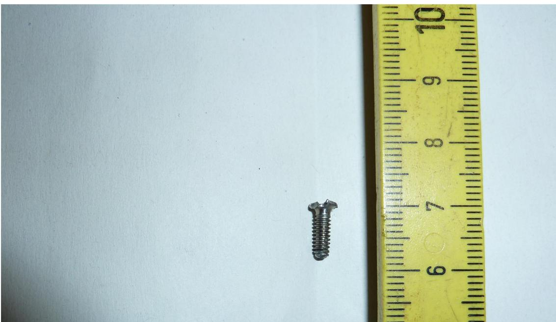
Figura 5.5: FOD colpevole dei danni della Figura 5.4. Fonte: Airgreen S.r.l.
