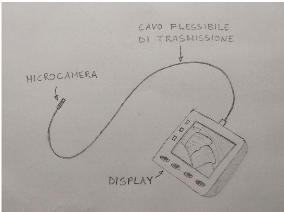
Figura 5.1: Disegno semplificato di un boroscopio digitale. Fonte: disegno dell'autore
