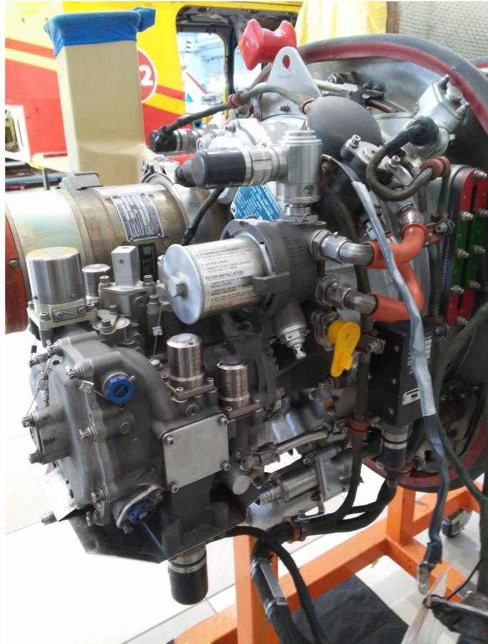
Figura 3.19: Vista di una parte dei componenti presenti sulla gearbox. Fonte: fotografia dell'autore
