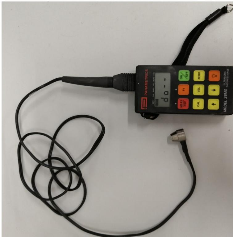
Figura 6.7: Spessimetro a Ultrasuoni
