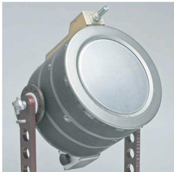
Figura 29 – Foto di un propulsore NSTAR
