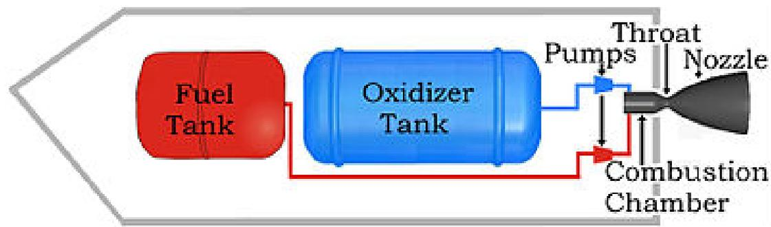
Figura 1: Schema Endoreattore a Propellenti Liquidi
