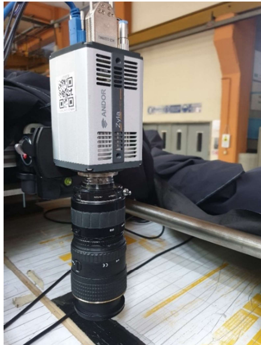
Figura 2.10: dettaglio telecamera sCMOS
