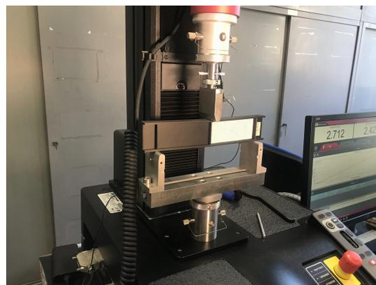
Figura 8.9: Strumentazione e inizio della prova di *three point bending*.
