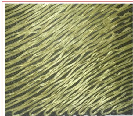
Figura 6.15: Ondulazione fibre, piastra 2.5mm.
