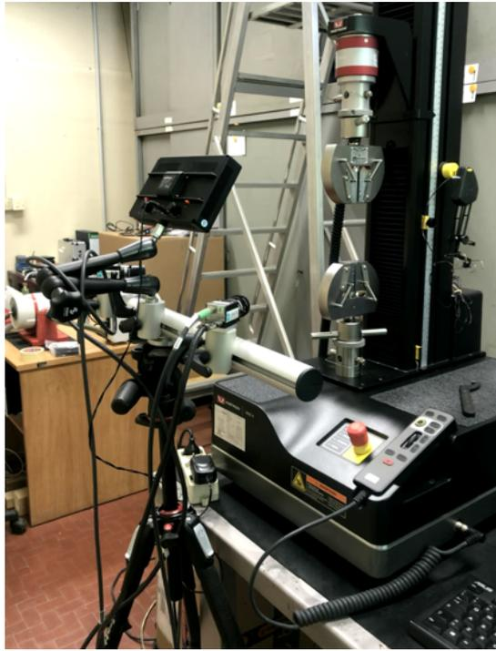
Figura 7.1: Macchina di prova e sistema di acquisizione.
