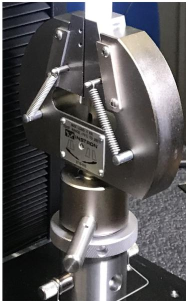
Figura 7.51: Dettaglio ganascia autoserrante.
