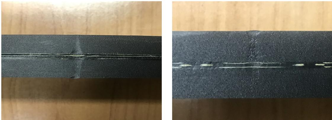
Figura 8.12: Delaminazione a seguito della prova di *three point bending*. A sinistra la trave a  $0^\circ/90^\circ/90^\circ/0^\circ$ , a destra la trave VAT.
