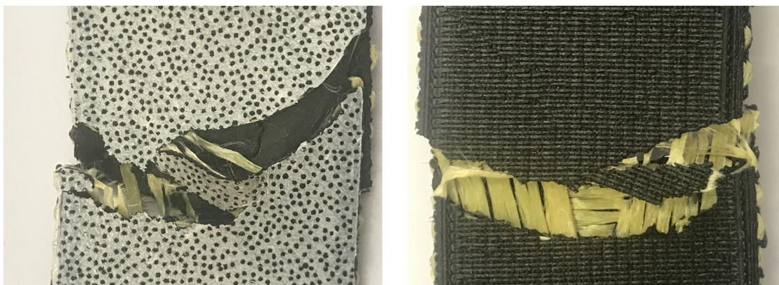
Figura 7.90: Rottura del provino con fibre circolari.
