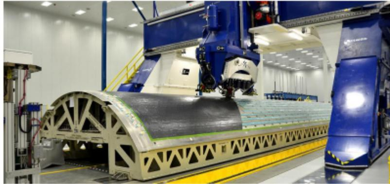
Figura 2.2: Produzione di strati con percorso in fibra curvilinea
