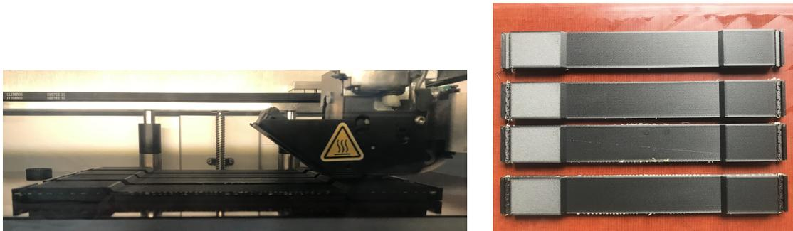
Figura 7.61: Stampa dei provini con tab a sinistra, provini stampati a destra
