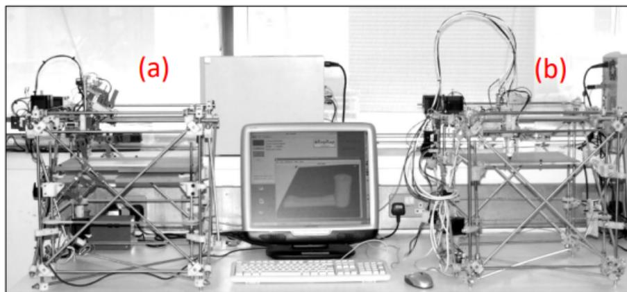
Figura 3.2: Prima stampante RepRap. a) Stampante di partenza, b) Stampante ottenuta.(52)
