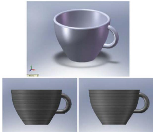
Figura 3.5: CAD di una tazzina da the: effetto della realizzazione usando spessori differenti (74)
