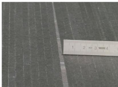
Figura 2.5: Rappresentazione di gap dovuto al disallineamento dei tow (63)
