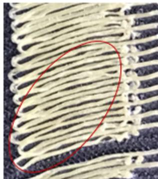
Figura 6.11: Ondulazione fibre, piastra 2mm.
