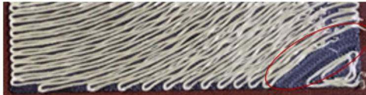
Figura 6.4: Difetto offset massimo, piastra 1.9mm.
