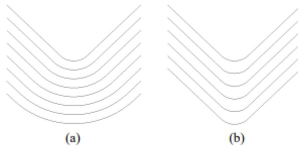
Figura 2.15: Definizione del percorso delle fibre: a) metodo parallelo, b) metodo shifting
