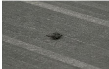
Figura 2.12: Formazione di peluria dovuta alla frizione con i componenti della macchina ATL/AFP
