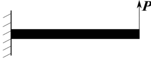
Figura 4.4: Condizioni al contorno della trave a sbalzo isotropa con  $L/t = 10$  soggetta a taglio trasversale
