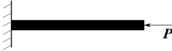
Figura 4.6: Condizioni al contorno della trave a sbalzo isotropa con  $\frac{L}{t} = 10$  soggetta a compressione assiale
