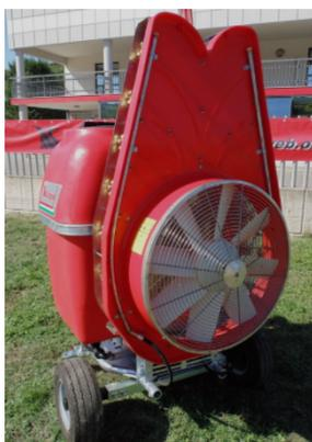
Figura 1.2: Atomizzatore a Torretta
