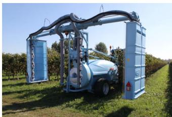
Figura 1.5: Nebulizzatore a Tunnel
