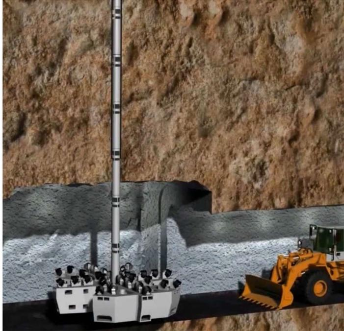
*Figura 48 – Completamento del foro pilota e sostituzione del tricono con l'alesatore*
