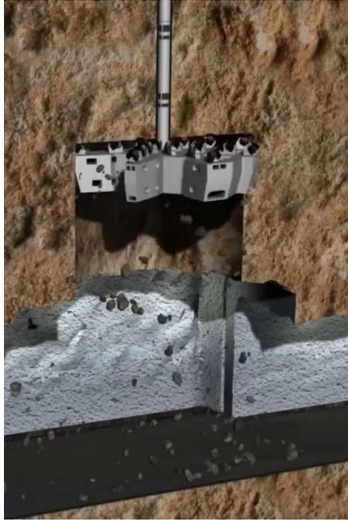
Figura 50 – Alesaggio del foro e produzione dello smarino
