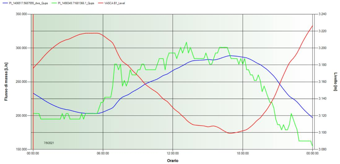
Fig. 8 Andamenti livelli e portate – vasca B1 – Portata in ingresso (blu) – Portata in uscita (verde)
