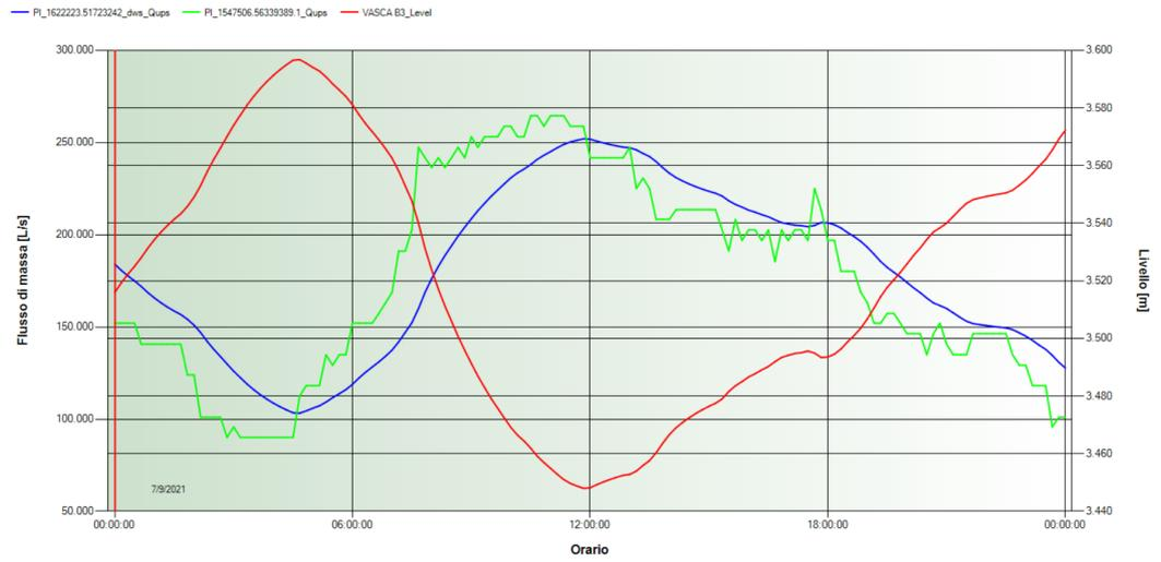
Fig. 10 Andamenti livelli e portate – vasca B3 - – Portata in ingresso (blu) – Portata in uscita (verde)
