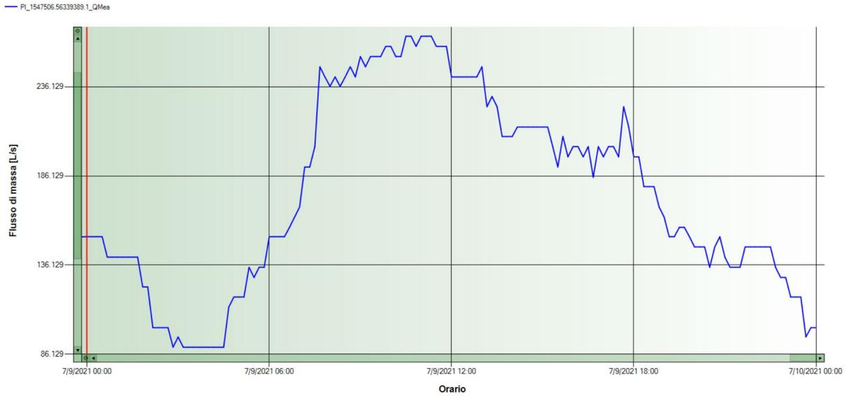
Fig. 11 Portata in uscita misurata – vasca B3
