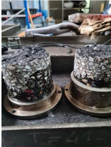
*Figura 19 - Modalità di rottura ideale dopo prova di fatica*
