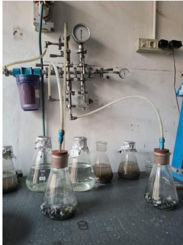
Figura 5 - Pompa di aspirazione; picnometri
