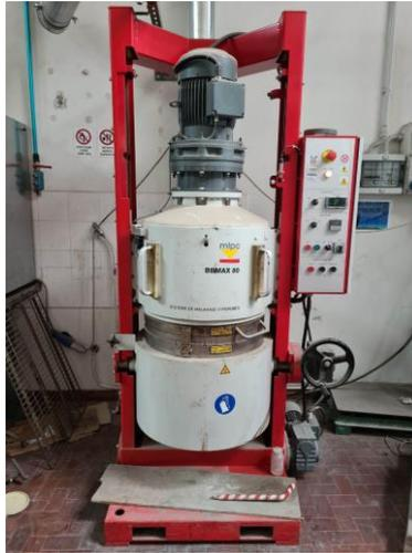
*Figura 8 - Miscelatore automatico per conglomerato bituminoso*
