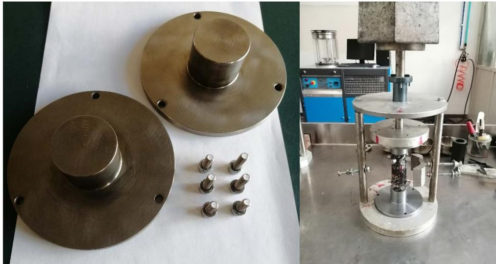
Figura 3.16 Piatti di carico AMPT (sinistra) e strumento per incollaggio piatti (destra)
