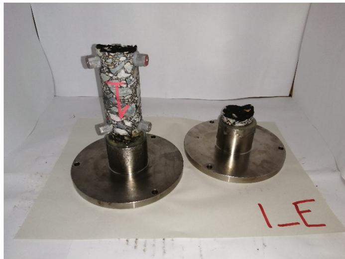
Figura 4.27 Esempio di "Edge failure"
