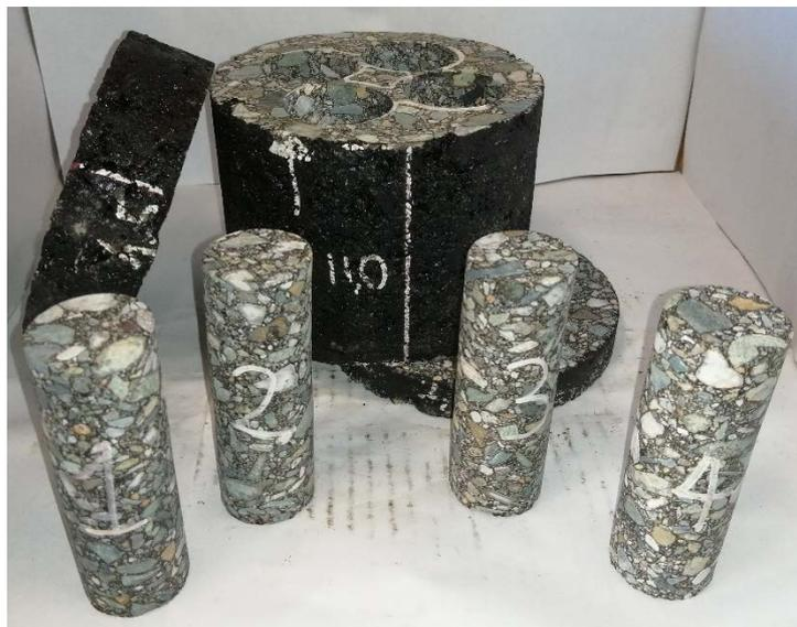
*Figura 3.8 Provino 150x180 mm tagliato e carotato per ottenere 4 provini 38x110 mm*
