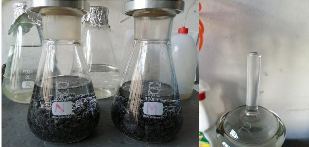
Figura 3.5 Picnometri sottovuoto (sinistra) e menisco d'acqua (destra)
