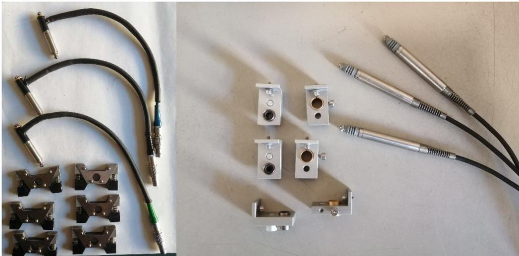
*Figura 3.17 Trasduttori e supporti per AMPT (sinistra) e UTM (destra)*
