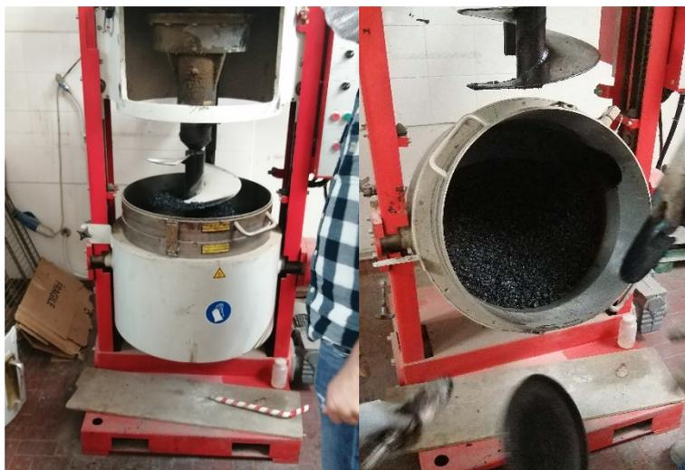
*Figura 3.4 Mixer automatico per miscelazione*
