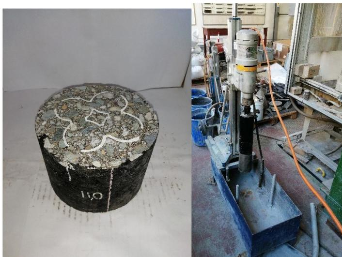
*Figura 3.11 Provino tagliato con linee guida per carotaggio (sinistra) e carotatrice (destra)*
