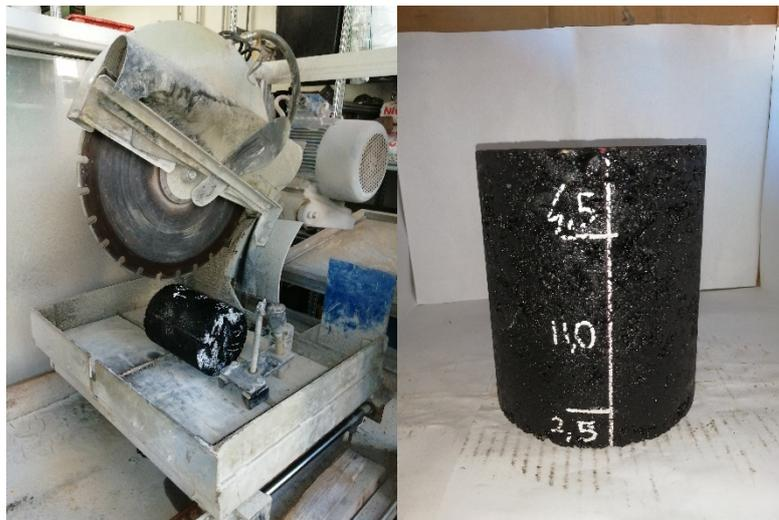
Figura 3.10 Taglierina diamantata (sinistra) e campione 150x180 mm con linee guida per il taglio (destra)
