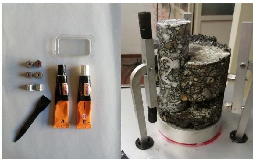
Figura 3.14 Prismi a base esagonale, colla bifase e strumento di incollaggio
