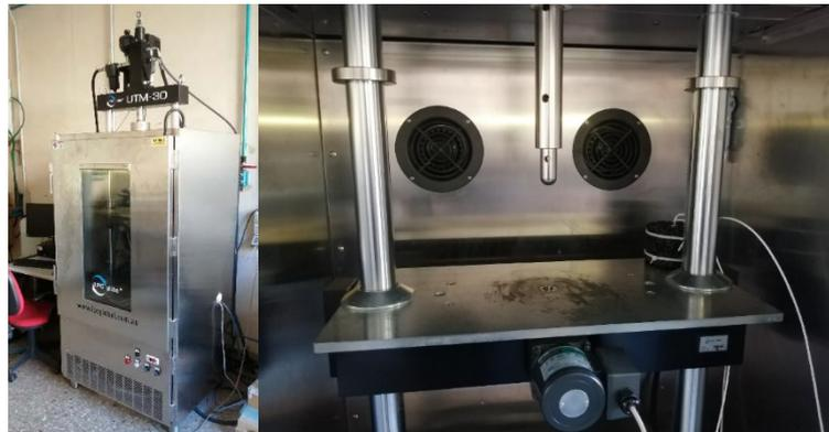
*Figura 3.12 Cella climatica UTM (sinistra) e interno, attuatore (destra)*
