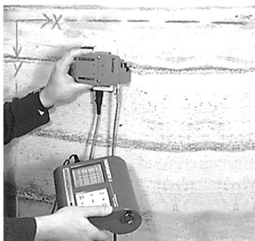
Figura 2.3. Applicazione del pacometro<sup>48</sup>
