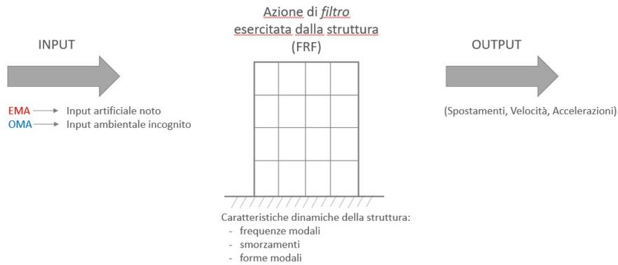
Figura 3.17. Rappresentazione schematica della modalità di identificazione dinamica
