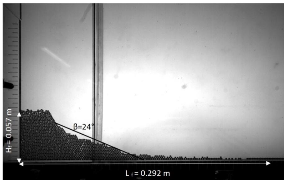
**Figura 29:** Istantanea finale di collasso con l'individuazione dei parametri geometrici del deposito reale – Colonna 55 mm.
