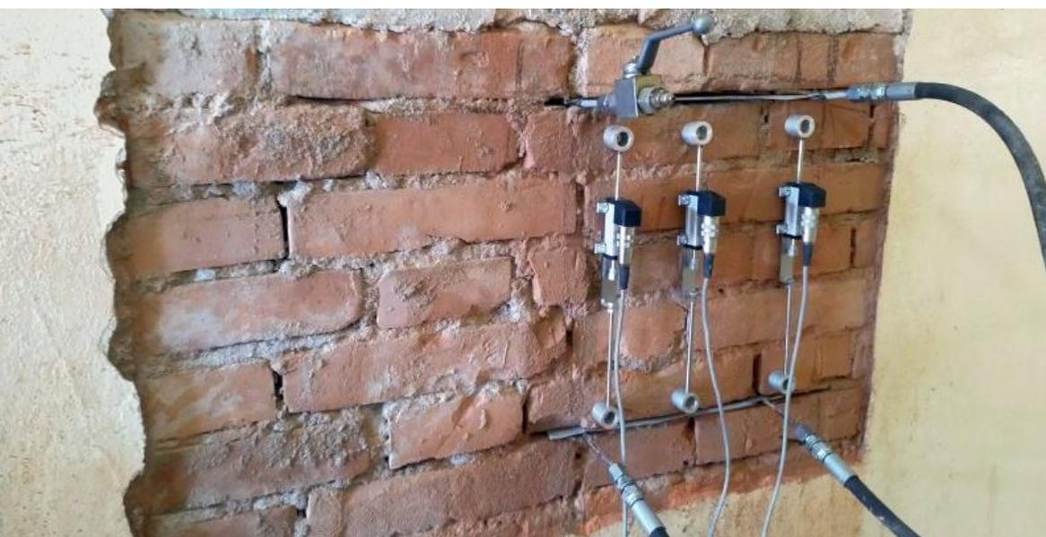
Figura 32 – Esempio di strumentazione per eseguire la prova di martinetto piatto doppio.
