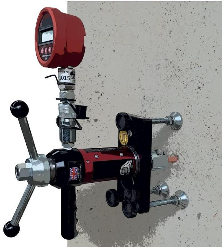
Figura 33 – Esempio di strumentazione per eseguire la prova di pull-out per tasselli.
