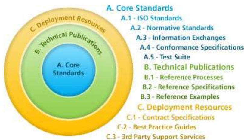
Figura 9 - Schema gerarchico del NBIMS-US. Fonte: National BIM Standard
