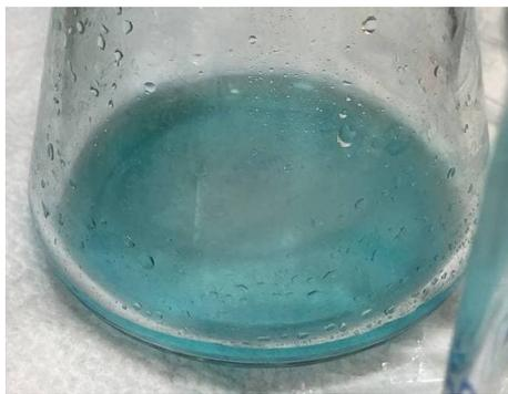
(a) Liquido della beuta con membrane fibrose di SBR non trattate.
