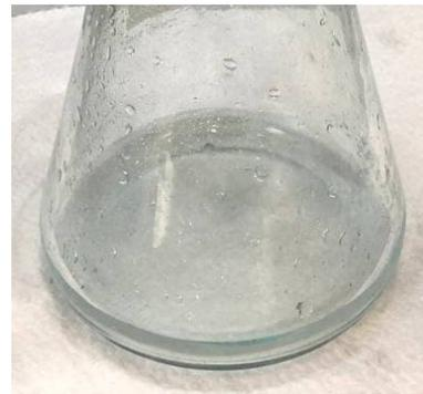
(b) Liquido della beuta con membrane fibrose di SBR dopo la funzionalizzazione.
