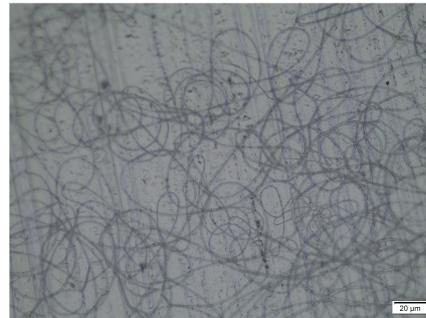
(b) Fibre di SBR dopo 5 minuti di irraggiamento.
