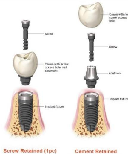
Figura 10: connessione a vite e connessione cementata.
