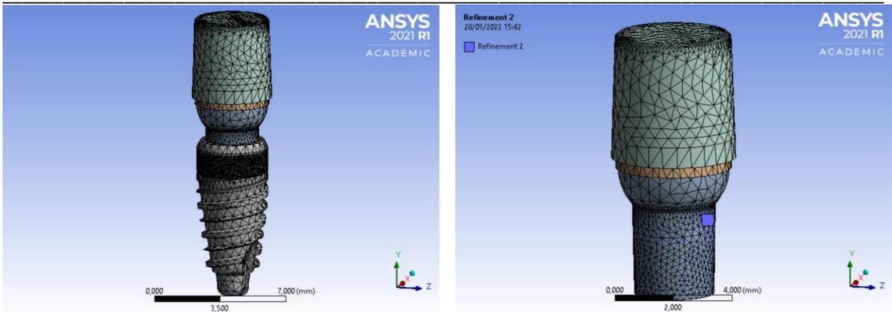
Figura 3.4: mesh tetraedrica di lato massimo pari a 0,5 mm. A destra, perfezionamento della mesh applicato alla porzione cilindrica del moncone.
