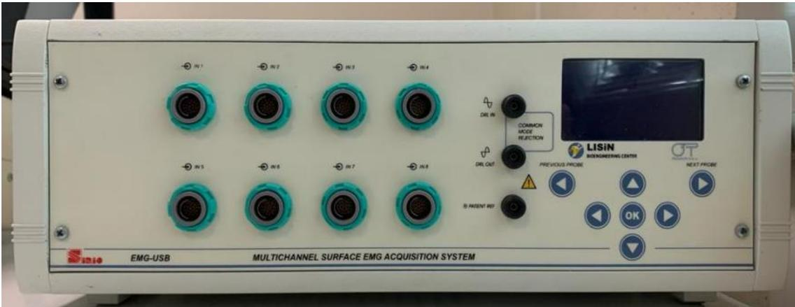
Figura 17. Pannello anteriore amplificatore EMG USB
