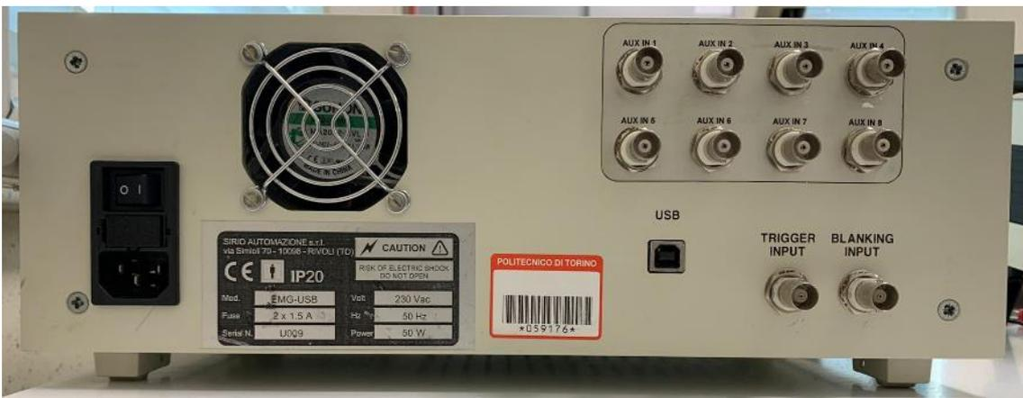
Figura 18. Pannello posteriore amplificatore EMG USB
