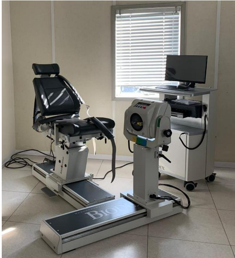
*Figura 13. Dinamometro isocinetico Biodex System 4 PRO*
