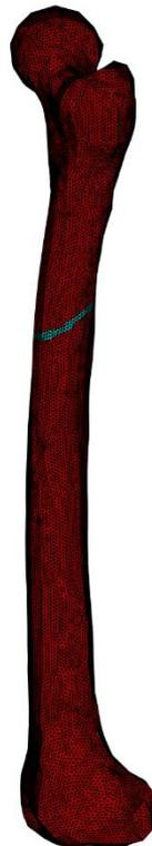
Figura 2.33: Risultato finale della creazione della frattura. In verde acqua sono riportati gli elementi appartenenti al set della frattura, in rosso i rimanenti.
